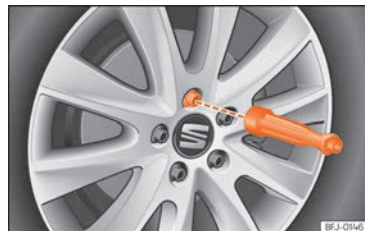
Abb. 256 Radwechsel: Radschrauben mit dem Schraubendrehergriff herausdrehen.
