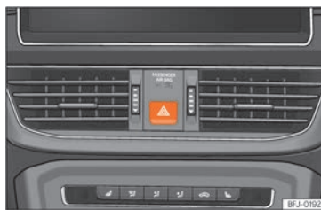
Abb. 49 Instrumententafel: Schalter für die Warnblinkanlage
