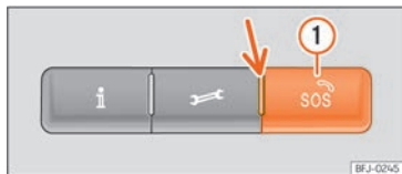
Abb. 50 In der Dachkonsole: Schalter für Sprachdienste
