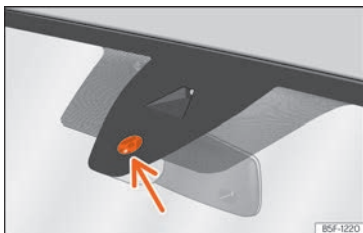
Abb. 109 Sensitive Fläche des Regensensors.
