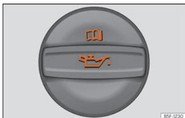
Abb. 242 Deckel der Motoröl-Einfüllöffnung im Motorraum.
