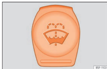
Abb. 238 Im Motorraum: Blauer Deckel des Scheibenwaschbehälters.
