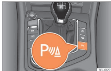
Abb. 158 Mittelkonsole: Taste für Einparkhilfe (je nach Ausführung).
