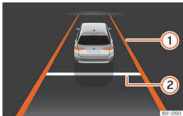
Abb. 148 Am Bildschirm des Kombi-Instruments: Anzeige bei aktiver Regelung (schematische Darstellung).
