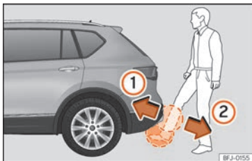
Abb. 78 Heckklappe mit sensorgesteuerter Öffnung (Easy Open).
