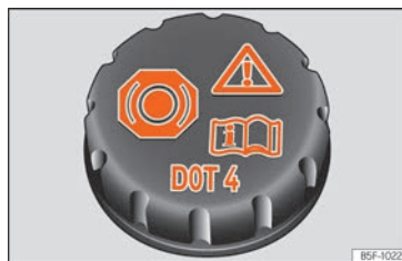
Abb. 237 Motorraum: Deckel des Bremsflüssigkeitsbehälters
