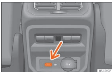
Abb. 185 Mittelkonsole hinten: USB-Anschlüsse mit Steckdosenfunktion.
