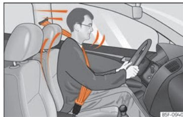
Abb. 21 Richtig angegurtete Fahrer werden bei einem plötzlichen Bremsmanöver nicht nach vorne geschleudert.
