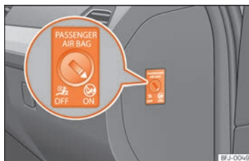
Abb. 32 Schlüsselschalter zum Ein- und Abschalten des Beifahrerairbags.
