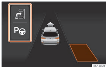
Abb. 162 Am Bildschirm des Kombi-Instruments: Anzeige des Parklenkassistenten mit eingeschränkter Sicht.
