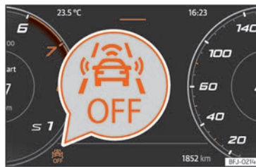
Abb. 146 Auf dem Display des Kombi-Instruments: Anzeige, dass Front Assist ausgeschaltet ist.
