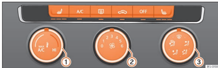
Abb. 113 In der Mittelkonsole: Bedienelemente der manuellen Klimaanlage.
