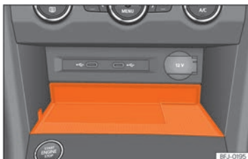
Abb. 192 In der Mittelkonsole: Aufnahme für die Mobiltelefonkopplung.
