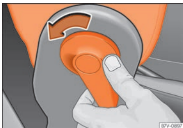
Abb. 90 Klappbare Beifahrersitzlehne entriegeln.
