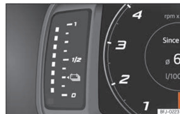
Abb. 8 Kombi-Instrument: Anzeige des Batterieladezustands.
