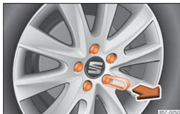
Abb. 250 Rad: Radschrauben mit Deckel.
