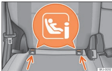
Abb. 41 Rücksitz: Einbauort der Halteösen ISOFIX oder i-Size.
