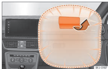
Abb. 31 Beifahrerairbag in der Instrumententafel
