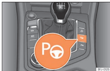
Abb. 161 In der Mittelkonsole: Taste zum Einschalten des Parkenassistenten.
