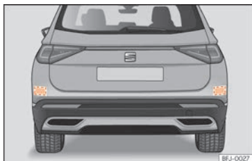
Abb. 134 Bereich hinter dem Fahrzeug: Bereiche der Radarsensoren.
