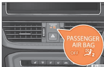
Abb. 33 Instrumententafel: Kontrollleuchte für abgeschalteten Beifahrerairbag.
