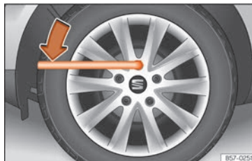
Abb. 252 Radwechsel: Radschrauben lockern
