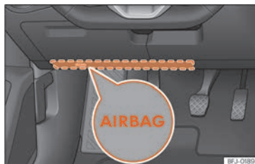
Abb. 36 Auf der Fahrerseite: Einbauort des Knieairbags.
