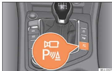
Abb. 170 Mittelkonsole: Taste zum manuellen Aktivieren und Deaktivieren der Rundumsicht in Verbindung mit dem Parklenkassistent.
