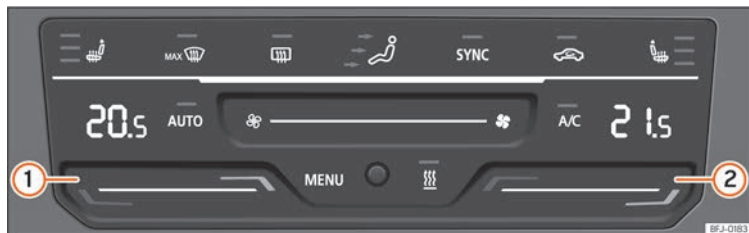
Abb. 112 In der Mittelkonsole: Bedienelemente der Climatronic.
