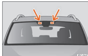
Abb. 116 Bereiche für das Anbringen elektronischen Zubehörs
