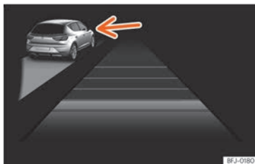
Abb. 188 Am Bildschirm des Kombi-Instruments: ACC aktiv, Fahrzeug auf der linken Seite erkannt
