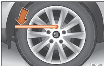
Abb. 35 Radwechsel: Radschrauben lockern.
