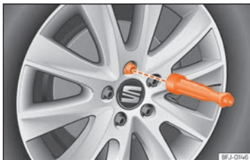
Abb. 39 Radwechsel: Radschrauben mit dem Schraubendrehergriff herausdrehen.
