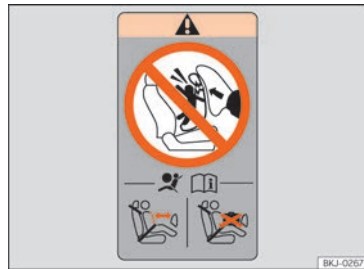
Abb. 25 Airbagaufkleber: Im hinteren Rahmen der Beifahrertür
