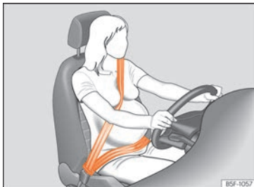
Abb. 13 Gurtbandverlauf bei schwangeren Frauen.
