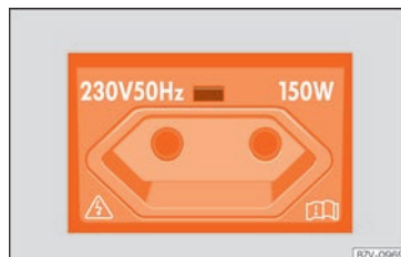
Abb. 146 Im Gepäckraum links: 230-Volt-Steckdose.
