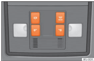
Abb. 93 Ausschnitt aus Dachhimmel:: Innenraumbeleuchtung vorn.
