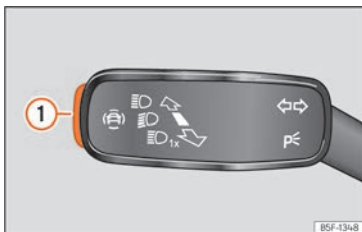
Abb. 60 Am Blinker- und Fernlichthebel: Taste für die Fahrerassistenzsysteme (modellabhängig).
