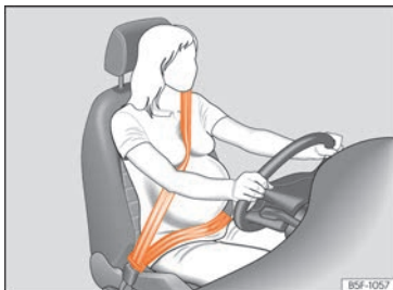
Abb. 13 Gurtbandverlauf bei schwangeren Frauen.
