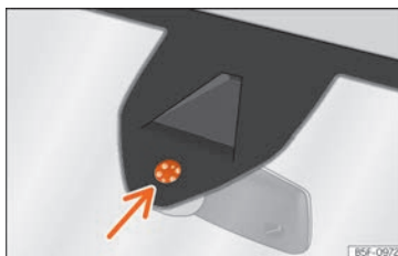
Abb. 96 Sensitive Fläche des Regensensors.
