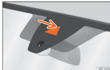
Abb. 169 An der Windschutzscheibe: Kamerasichtfenster des Spurhalteassistenten.
