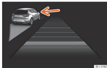
Abb. 182 Am Bildschirm des Kombi-Instruments: ACC aktiv, Fahrzeug auf der linken Seite erkannt
