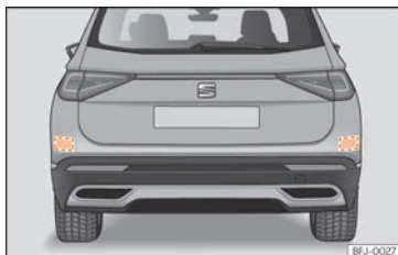
Abb. 170 Heckansicht des Fahrzeugs: Bereiche der Radarsensoren.
