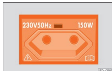
Abb. 142 Im Gepäckraum links: 230-Volt-Steckdose.
