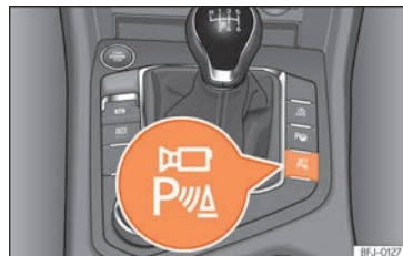
Abb. 210 Mittelkonsole: Taste zum manuellen Aktivieren und Deaktivieren der Rundumsicht in Verbindung mit dem Parklenkassistent.
