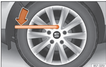
Abb. 35 Radwechsel: Radschrauben lockern.
