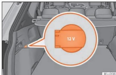
**Abb. 151** Detail an der Seitenverkleidung des Gepäckraums: 12-Volt-Steckdose.
