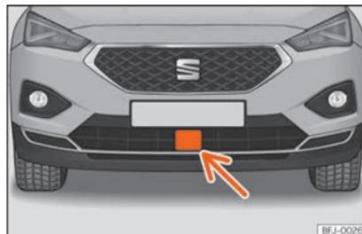
**Abb. 258** Am vorderen Stoßfänger: Radarsensor.
