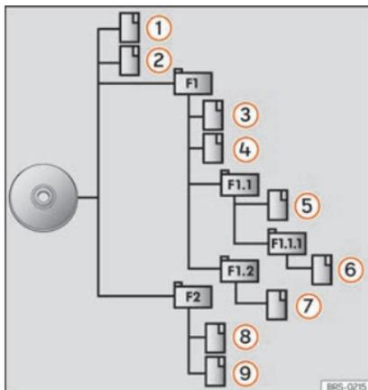
**Abb. 188** Mögliche Struktur einer Audiodaten-CD.
