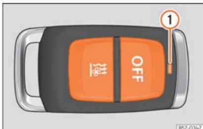
**Abb. 159** Standheizung: Funkfernbedienung.
