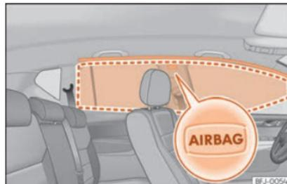
Abb. 23 Einbauort der Kopfairbags
