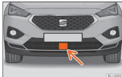
**Abb. 264** Am vorderen Stoßfänger: Radarsensor.
