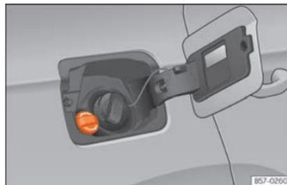
**Abb. 306** Verschlussdeckel des AdBlue-Tanks
