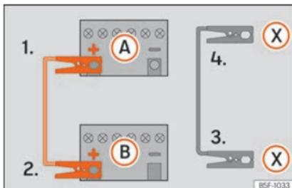
**Abb. 47** Anschlusschema für Fahrzeuge mit Start-Stopp-System.
