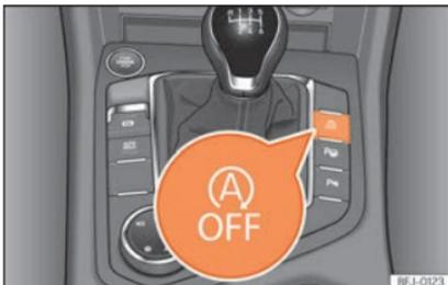
**Abb. 243** Mittelkonsole: Taste des Start-Stopp-Systems.
