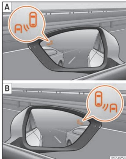
**Abb. 273** An den Außenspiegeln: Anzeige des Blind-Spot-Assistenten. »
