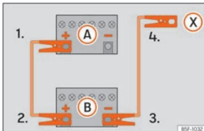
**Abb. 46** Anschlusschema für Fahrzeuge ohne Start-Stopp-System.
