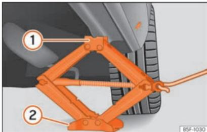
**Abb. 41** Längsholm: Wagenheber ansetzen.
