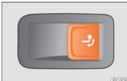
**Abb. 301** Im Gepäckraum rechts: Taste zur Entriegelung der Anhängerkupplung.
