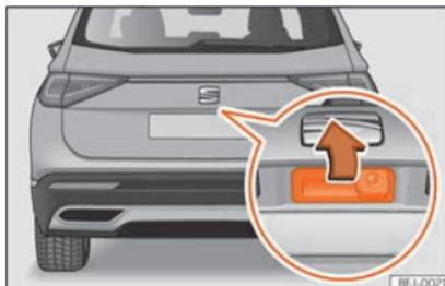
**Abb. 84** Heckklappe: Haltegriff
