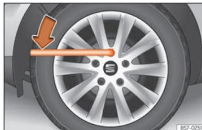
Abb. 38 Radwechsel: Radschrauben lockern.
