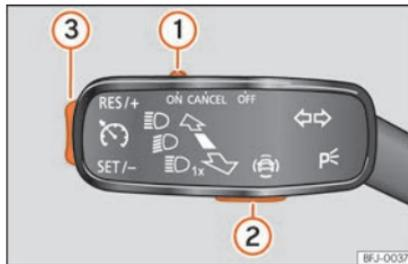
**Abb. 254** Am Blinkerhebel: Tasten zur Bedienung des Geschwindigkeitsbegrenzers.
