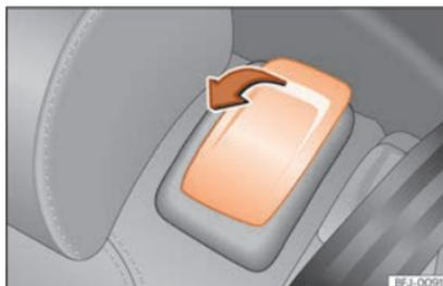
**Abb. 116** Zweite Sitzreihe: Bedienungselemente der Einstiegsilfe.
