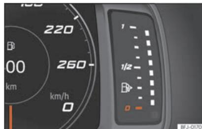
**Abb. 62** Frei konfigurierbares Kombiinstrument: Kraftstoffvorratsanzeige
