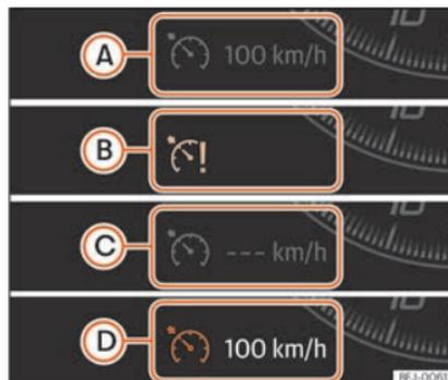
Abb. 251 Bildschirm des Kombi-Instruments: Zustandsanzeigen der GRA.
