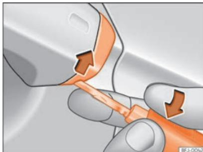
**Abb. 81** Fahrertürgriff: Abdeckklappe abhebeln.
