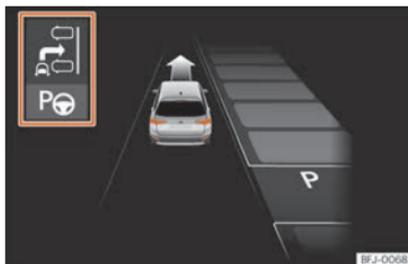
**Abb. 282** Am Bildschirm des Kombi-Instrumenten: Anzeige des Parklenkassistenten mit eingeschränkter Sicht.
