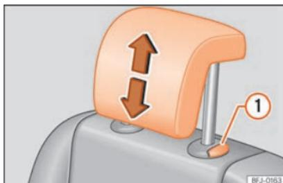
**Abb. 114** Hintere Kopfstützen ausbauen: Zweite Sitzreihe.
