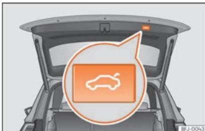
**Abb. 85** Heckklappe: Taste zum Schließen der Heckklappe.
