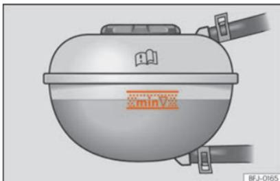
**Abb. 313** Im Motorraum: Markierung an dem Motorraumkühlmittelausgleichsbehälter.
