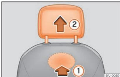
**Abb. 113** Kopfstützen vorne: Ausbau.
