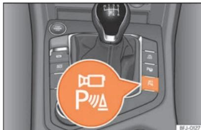
**Abb. 294** Mittelkonsole: Taste zum manuellen Aktivieren und Deaktivieren der Rundumsicht in Verbindung mit dem Parklenkassistent.
