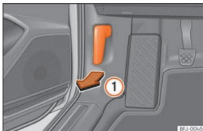
**Abb. 308** Entriegelungshebel im Fahrerfußraum.
