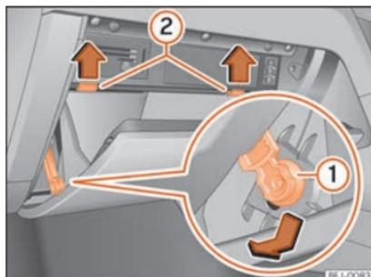
**Abb. 53** Handschuhfach (Rechtslenker): Zugang zum Sicherungskasten.
