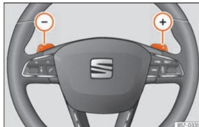
**Abb. 247** Lenkrad: Hebel für Automatikgetriebe.
