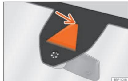
**Abb. 270** An der Windschutzscheibe: Kamera-sichtfenster des Spurhalteassistenten.
