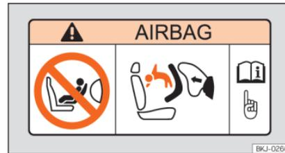
Abb. 26 Airbagaufkleber: an der Sonnenblende auf der Beifahrerseite
