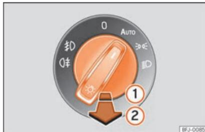
**Abb. 95** Instrumententafel: Lichtschalter.
