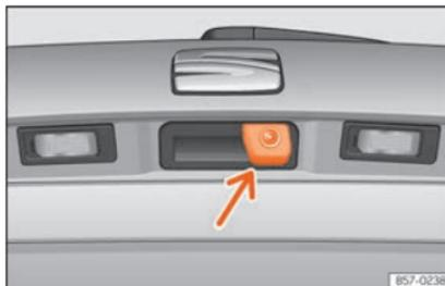
**Abb. 297** Im Griff der Heckklappe: Einbauort der Kamera des Rückfahrassistenten.
