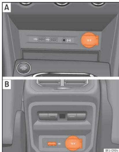
**Abb. 150** [A] Mittelkonsole: 12-Volt-Steckdose vorne. [B] Hintere Seite der Mittelkonsole: USB- und 12-Volt-Steckdosen.
