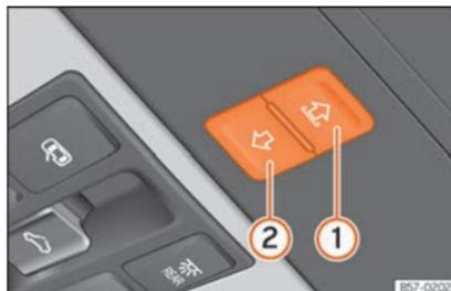
**Abb. 91** Im Dachhimmel: Tasten des Sonnenschutzrollos.
