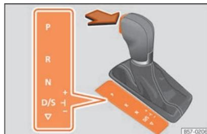
Abb. 245 Wählhebelsperre.
