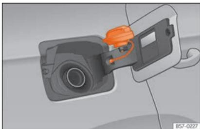
**Abb. 303** Tankklappe mit aufgestecktem Tankverschluss.
