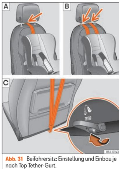
**Abb. 31** Beifahrersitz: Einstellung und Einbau je nach Top Tether-Gurt.
