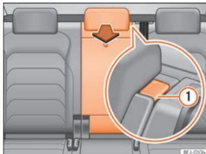
**Abb. 134** Rückstuhllehne: Öffnung der Durchladeeinrichtung.
