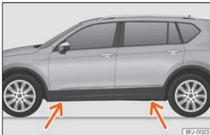
**Abb. 40** Aufnahmepunkte für den Wagenheber.
