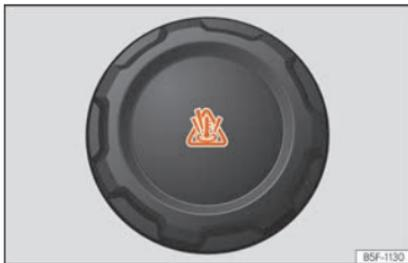
**Abb. 314** Motorraum: Deckel des Motorraumkühlmittelausgleichsbehälters.
