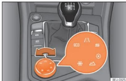
**Abb. 249** Mittelkonsole: Drehknopf (Driving Experience button).
