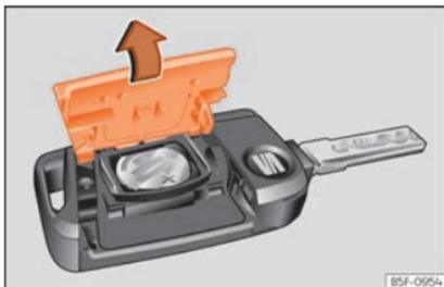
**Abb. 73** Fahrzeugschlüssel: Deckel des Batteriefachs öffnen.
