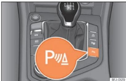
Abb. 288 Mittelkonsole: Taste für Einparkhilfe.
