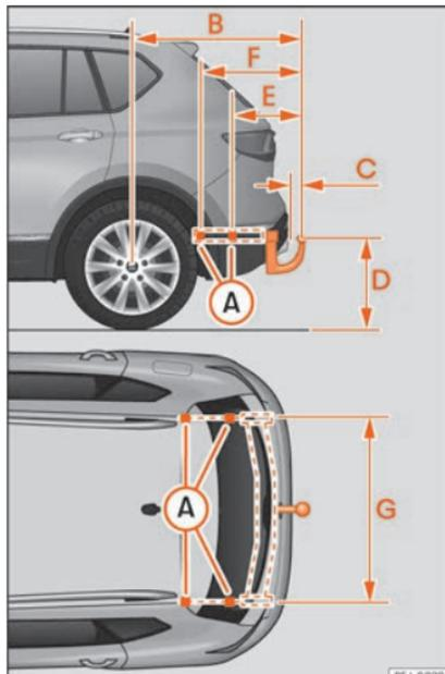
**Abb. 302** Maße und Befestigungspunkte für den nachträglichen Einbau einer Anhängervorrichtung
