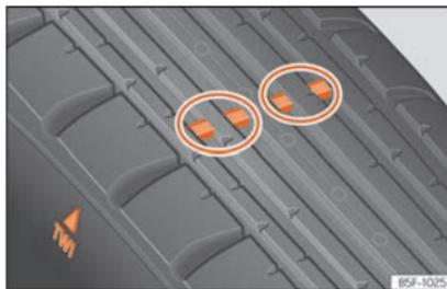
Abb. 318 Reifenprofil: Verschleißanzeiger.
