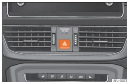
**Abb. 98** Instrumententafel: Schalter für Warnblinkanlage.
