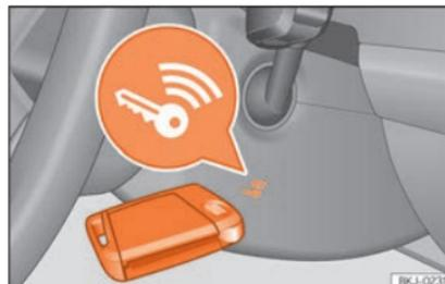
**Abb. 241** Rechts an der Lenksäule: Notstart.
