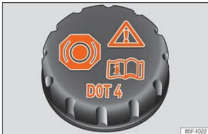
**Abb. 315** Motorraum: Deckel des Bremsflüssigkeitsbehälters.
