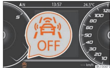
**Abb. 259** Am Bildschirm des Kombi-Instruments: Anzeige, dass Front Assist ausgeschaltet ist.
