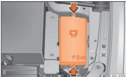
**Abb. 54** Im Motorraum: Abdeckung des Sicherungskasten.
