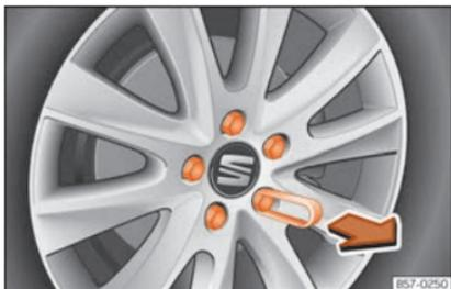
Abb. 36 Rad: Radschrauben mit Deckel.
