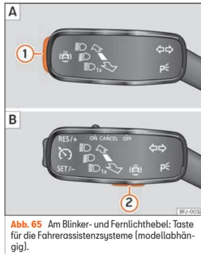
**Abb. 65** Am Blinker- und Fernlichthebel: Taste für die Fahrerassistenzsysteme (modellabhängig).
