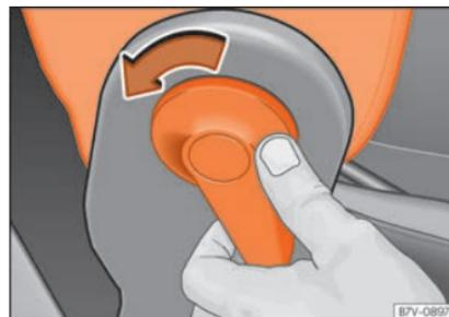
**Abb. 118** Klappbare Beifahrersitzlehne entriegeln.
