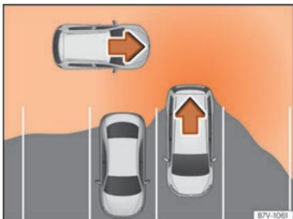
**Abb. 277** Schematische Abbildung des Ausparkassistenten: Überwachter Bereich des ausparkenden Fahrzeugs.
