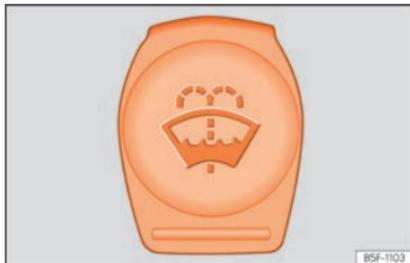
**Abb. 316** Im Motorraum: Deckel des Scheibenwaschbehälters.
