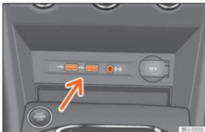
**Abb. 236** Mittelkonsole: USB/AUX-IN Anschluss.
