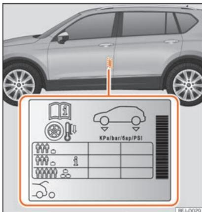
**Abb. 317** Einbauort des Aufklebers für den Reifendruck.
