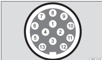
**Abb. 300** Schematische Darstellung: Zuweisung der Steckverbinderstifte für Anhängerstrom.
