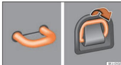
Abb. 131 Im Gepäckraum: feststehende und herausklappbare Verzurrösen.
