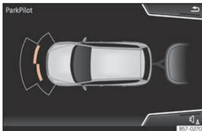
**Abb. 291** Bildschirmanzeige der Einparkhilfe im Anhängerbetrieb.
