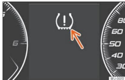
Abb. 320 Kombi-Instrument: Warnung Reifen-druckverlust.
