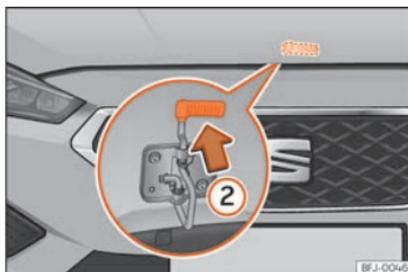
**Abb. 309** Hebel unter der Motorraumklappe.
