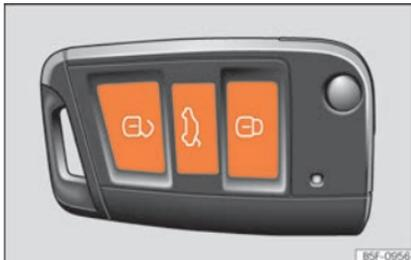
Abb. 75 Funkschlüssel: Tasten.
