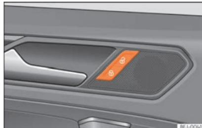
Abb. 76 Fahrertür: Zentralverriegelungstaster.
