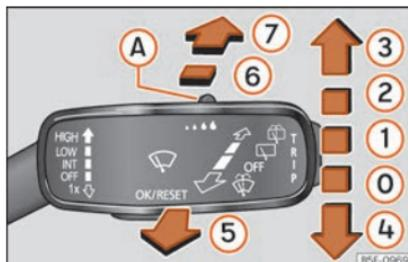
**Abb. 101** Bedienung von Windschutz- und Heckscheibenwischer
