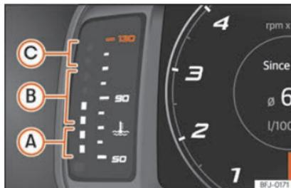
Abb. 63 Frei konfigurierbares Kombiinstrument: Motorkühlmittel-Temperaturanzeige.
