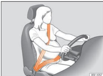
**Abb. 13** Gurtbandverlauf bei schwangeren Frauen.
