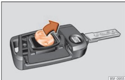
**Abb. 74** Fahrzeugschlüssel: Batterie herausnehmen.
