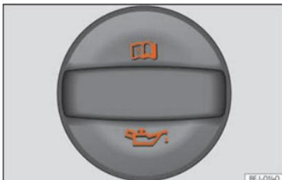
**Abb. 312** Deckel der Motoröl-Einfüllöffnung im Motorraum
