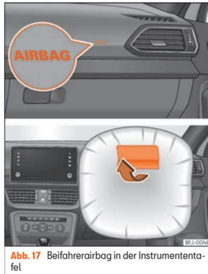
Abb. 17 Beifahrerairbag in der Instrumententafel
