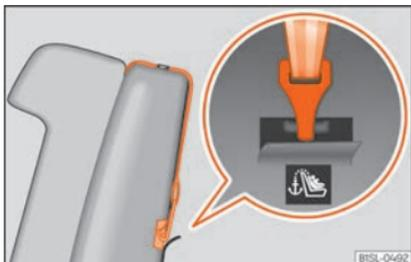
**Abb. 28** Beispiel eines eingehängten oberen Befestigungsgurtes.
