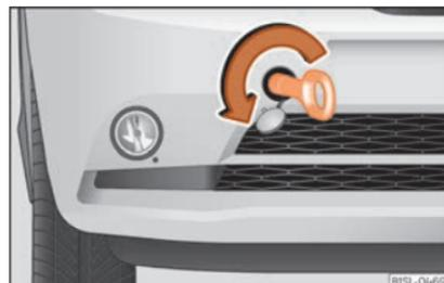
Abb. 59 Vorderer Stoßfänger rechts: Eingeschraubte Abschleppöse
