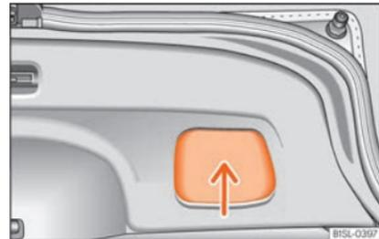
**Abb. 7** Offene Heckklappe: Griffmulde zum Ziehen
