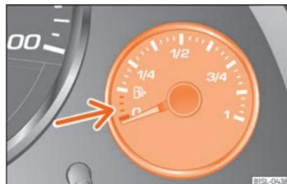
**Abb. 177** Im Kombiinstrument: Kraftstoffvorratsanzeige für Benzin.
