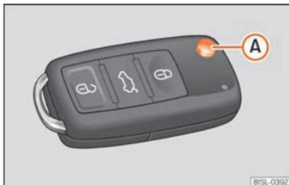
Abb. 97 Schlüssel mit Funkfernbedienung.
