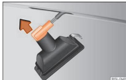
**Abb. 92** Kennzeichenleuchte: Lampenträger ausbauen.
