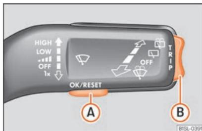
**Abb. 34** Scheibenwischerhebel: Steuertasten.
