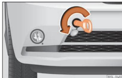
**Abb. 82** Im Stoßfänger vorn rechts: Abschleppöse einschrauben.
