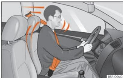
**Abb. 70** Richtig angegurte Fahrer werden bei einem plötzlichen Bremsmanöver nicht nach vorne geschleudert.
