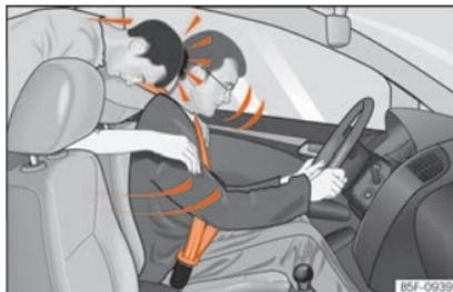
**Abb. 72** Der nicht angegurte Mitfahrer auf dem Rücksitz schleudert nach vorn auf den angegurten Fahrer.
