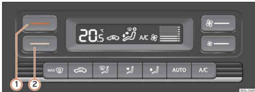
**Abb. 142** Im oberen Teil der Mittelkonsole: Bedienelemente der Climatronic.
