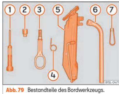
**Abb. 79** Bestandteile des Bordwerkzeugs.
