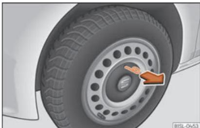
**Abb. 51** Radmittenblende an der Stahlfelge abziehen.
