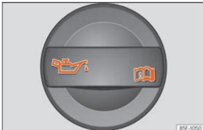
Abb. 42 Deckel der Motoröl-Einfüllöffnung im Motorraum
