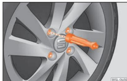
**Abb. 58** Radwechsel: Radschrauben mit dem Schraubendrehergriff abschrauben.
