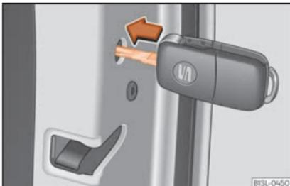
**Abb. 6** Notverriegelung des Fahrzeugs mit dem Fahrzeugschlüssel.
