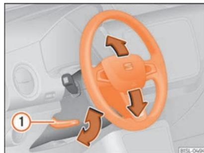
**Abb. 18** Lenkradposition mechanisch einstellen.
