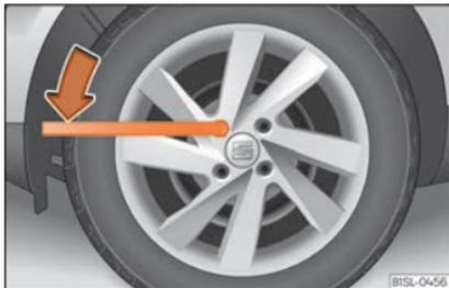
Abb. 54 Radwechsel: Radschrauben lockern.
