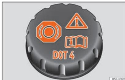
**Abb. 44** Motorraum: Deckel des Bremsflüssigkeitsbehälters
