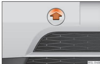
**Abb. 81** Im Stoßfänger vorn rechts: Abdeckung abnehmen.
