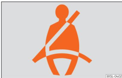
Abb. 68 Warnleuchte im Kombiinstrument.
