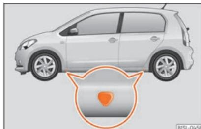
**Abb. 56** Aufnahmepunkte für den Wagenheber.
