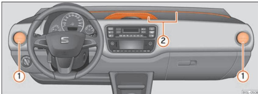
Abb. 141 Auf der Schalttafel: Luftzerstäuber.
