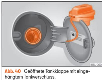
**Abb. 40** Geöffnete Tankklappe mit eingehängtem Tankverschluss.
