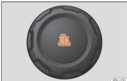
**Abb. 184** Im Motorraum: Deckel des Motorkühlmittelausgleichsbehälters.
