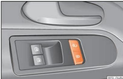
Abb. 3 An der Fahrertür: Zentralverriegelungstaster.
