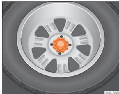
**Abb. 190** Im Gepäckraum: Handrad zur Befestigung des Reserverads.
