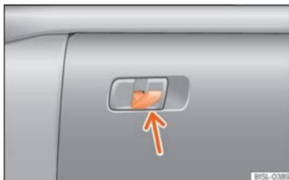
Abb. 125 Ablagefach auf der Beifahrerseite: klappbarer Haken.
