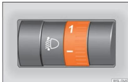
**Abb. 112** Neben dem Lenkrad: Regler für die Leuchtweitenregulierung.
