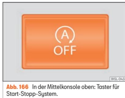
**Abb. 166** In der Mittelkonsole oben: Taster für Start-Stopp-System.
