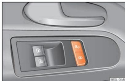
**Abb. 104** An der Fahrertür: Zentralverriegelungstaster.
