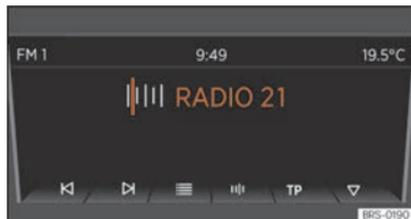
**Abb. 147** Wechsel zum nächsten empfangbaren Sender über die Pfeiltasten.
