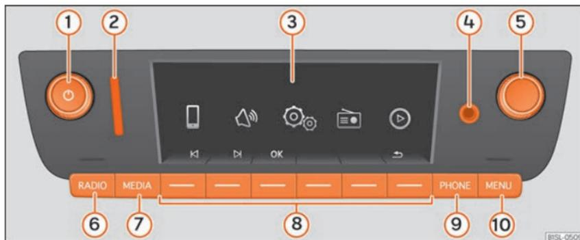
Abb. 144 Übersicht der Bedienelemente.
