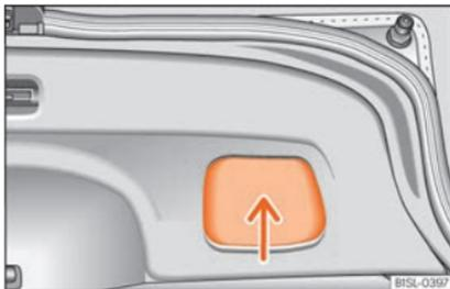
**Abb. 108** Offene Heckklappe: Griffmulde zum Zuziehen
