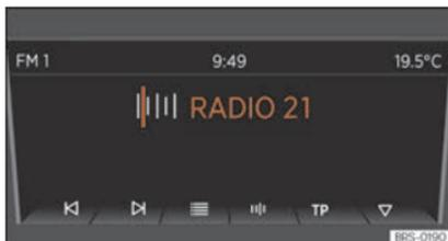
**Abb. 151** Anzeige im Radiomodus: Sender mit Pfeiltasten wechseln.
