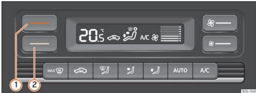
**Abb. 38** Im oberen Teil der Mittelkonsole: Bedienelemente der Climatronic.
