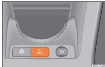
**Abb. 189** Mittelkonsole: Taste für die Reifenkontrollanzeige
