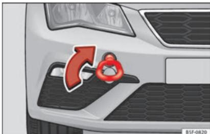
**Abb. 98** Vorderer Stoßfänger rechts: Eingeschraubte Abschleppöse
