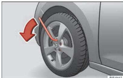
**Abb. 74** Rad: Radschrauben lockern.
