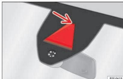
**Abb. 216** Kamerasichtfenster des Spurhalteassistenten.
