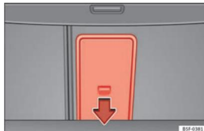
Abb. 176 Im Gepäckraum: Öffnung der Durchladeeinrichtung.
