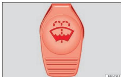
**Abb. 65** Im Motorraum: Deckel des Scheibenwaschbehälters.
