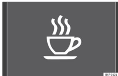
Abb. 223 Im Display des Kombi-Instruments: Symbol der Müdigkeitserkennung.
