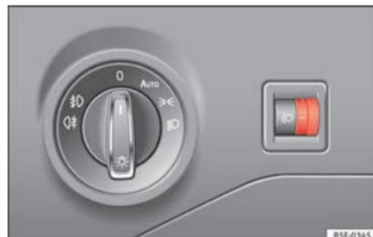
**Abb. 144** Neben dem Lenkrad: Regler für die Leuchtweitenregulierung.
