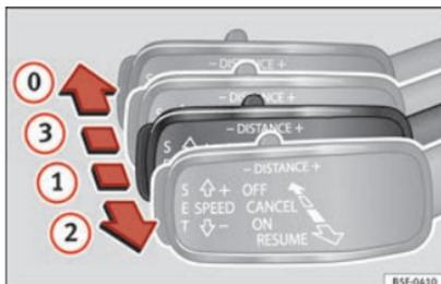
**Abb. 211** Auf der linken Seite der Lenksäule: dritter Hebel für die Betätigung der automatischen Distanzregelung.
