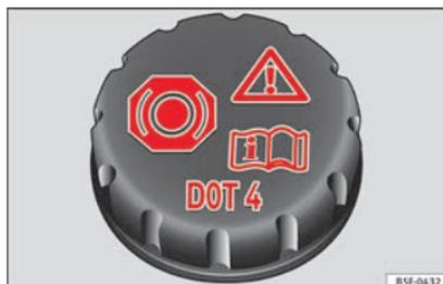
**Abb. 64** Motorraum: Deckel des Bremsflüssigkeitsbehälters
