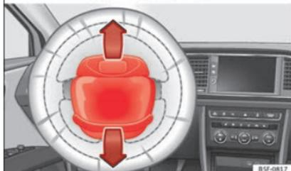
**Abb. 20** Einbauort Fahrerairbag: im Lenkrad.
