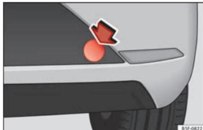
**Abb. 99** Hinterer Stoßfänger rechts: Abdeckplatte-Deckel.
