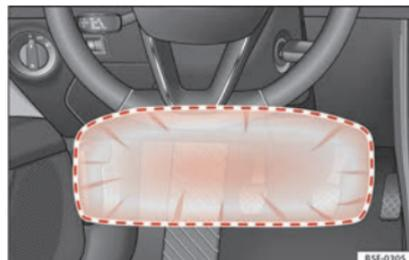
Abb. 25 Auf der Fahrerseite: Wirkungsbereich des Knieairbags.
