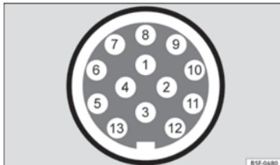
**Abb. 243** Schematische Darstellung: Zuweisung der Steckverbinderstifte für Anhängerstrom.
