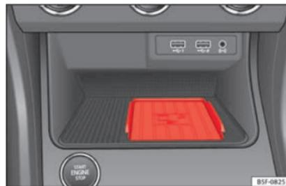
Abb. 131 Mittelkonsole: Connectivity Box
