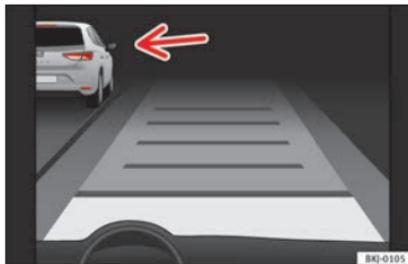
**Abb. 213** Im Display des Kombiinstrumentes: ACC aktiv, Fahrzeug auf der linken Seite erkannt
