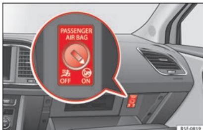
Abb. 22 Schalter für Beifahrer-Frontairbag.
