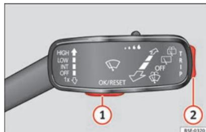
**Abb. 43** Scheibenwischerhebel: Steuertasten.
