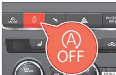
Abb. 201 Mittelkonsole: Systemtaste Start-Stopp.
