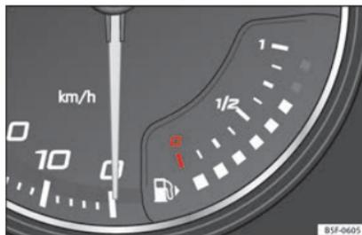
**Abb. 125** Kombiinstrument: Erdgas-/Diesel-vorratsanzeige
