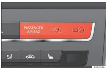
Abb. 23 Instrumententafel: Kontrollleuchte für abgeschalteten Beifahrerairbag.
