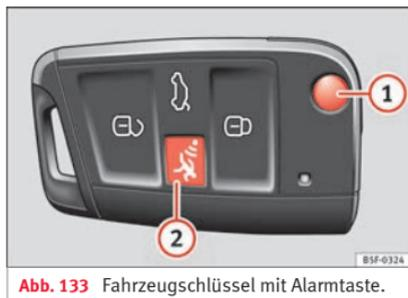
Abb. 133 Fahrzeugschlüssel mit Alarmtaste.
