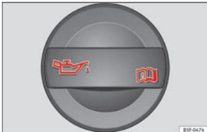
Abb. 249 Deckel der Motoröl-Einfüllöffnung im Motorraum
