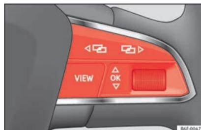
**Abb. 44** Rechte Seite Multifunktions-Lenkrad: Steuertasten.
