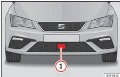
**Abb. 210** Im vorderen Stoßfänger: Radarsensor.
