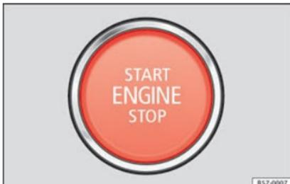
**Abb. 192** Im unteren Bereich der Mittelkonsole: Starterknopf.
