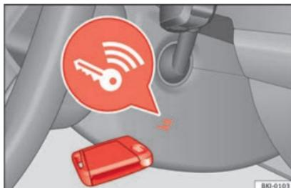
**Abb. 193** Rechts an der Lenksäule: Notstart.
