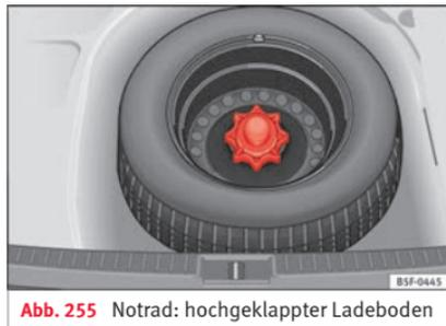
Abb. 255 Notrad: hochgeklappter Ladeboden
