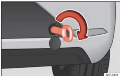
**Abb. 78** Hinterer Stoßfänger rechts: Eingeschraubte Abschleppöse
