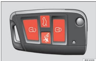
Abb. 1 Funkschlüssel: Tasten
