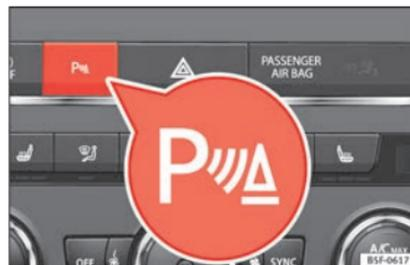
Abb. 226 Mittelkonsole: Taste für Einparkhilfe.
