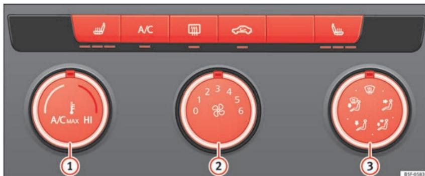
**Abb. 58** In der Mittelkonsole: Bedienelemente der manuellen Klimaanlage.
