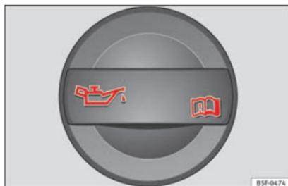
Abb. 62 Deckel der Motoröl-Einfüllöffnung im Motorraum
