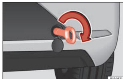
**Abb. 100** Hinterer Stoßfänger rechts: Eingeschraubte Abschleppöse
