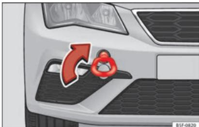
**Abb. 77** Vorderer Stoßfänger rechts: Eingeschraubte Abschleppöse
