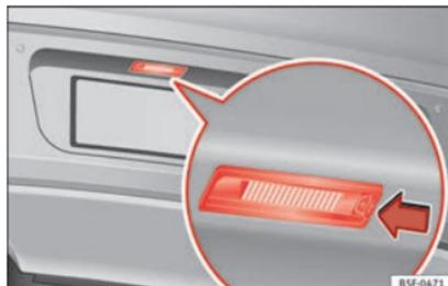
**Abb. 118** Im Stoßfänger hinten: Kennzeichenbeleuchtung.
