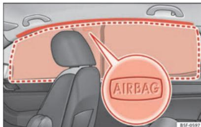
Abb. 28 Einbauort der Kopfairbags
