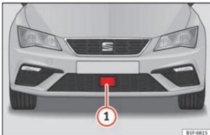
**Abb. 205** Im vorderen Stoßfänger: Radarsensor.
