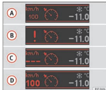
Abb. 203 Display des Kombiinstruments: Zustandsanzeigen der GRA.
