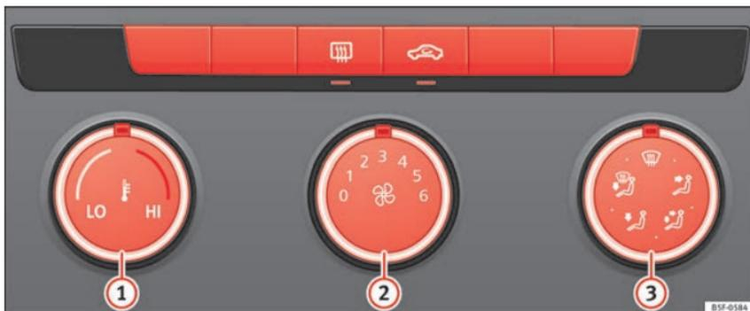
Abb. 59 Mittelkonsole: Systembedienungen für Heiz- und Frischluft
