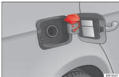
**Abb. 60** Tankklappe mit aufgestecktem Tankverschluss.
