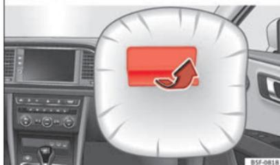
**Abb. 21** Beifahrerairbag in der Instrumententafel
