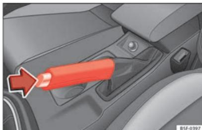
Abb. 196 Handbremse zwischen den Vordersitzen.
