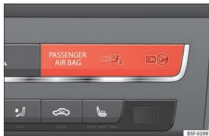
**Abb. 53** Kontrolllampchen für Abschaltung des und Beifahrerairbags.
