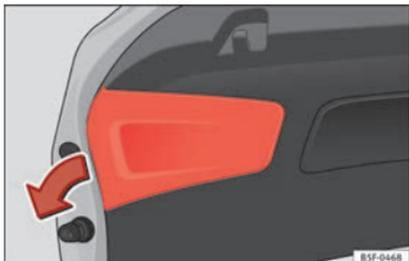
**Abb. 116** Abdeckung der Heckklappe entfernen
