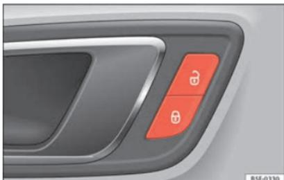
Abb. 2 Fahrertür: Taste Zentralverriegelung.
