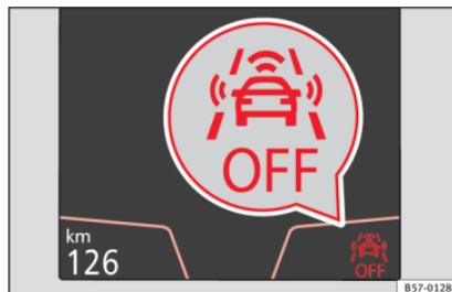
**Abb. 206** Auf dem Display des Kombi-Instruments: Anzeige, dass Front Assist ausgeschaltet ist.
