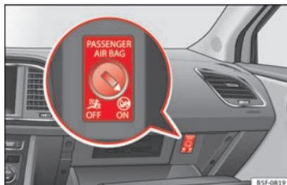
**Abb. 95** Schlüsselschalter zum Ein- und Abschalten des Beifahrerairbags.
