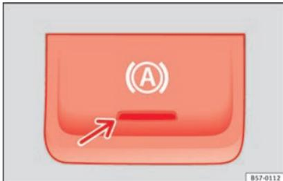
**Abb. 202** Im unteren Bereich der Mittelkonsole: Funktionstaste Auto-Hold.
