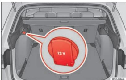
**Abb. 162** Detail an der Seiteninnenverkleidung des Kofferraums: Steckdose 12 V (gilt nur für das Modell LEON ST).
