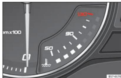
Abb. 124 Kombiinstrument: Kühlmitteltemperatur-Anzeige.
