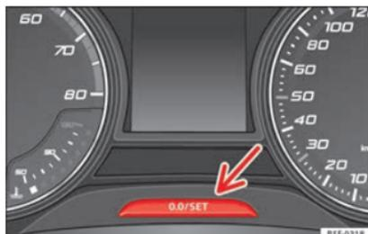
Abb. 123 Kombi-Instrument: Kilometerzähler und Rückstelltaste.
