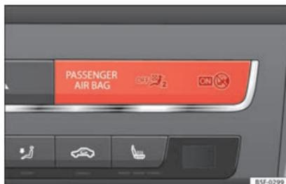
**Abb. 96** Instrumententafel: Kontrollleuchte für abgeschalteten Beifahrerairbag.
