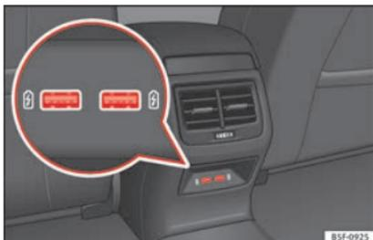
Abb. 129 Mittelkonsole hinten: USB-Anschlüsse.
