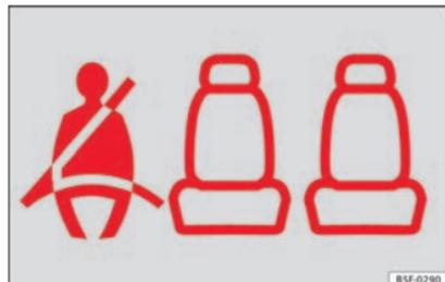
**Abb. 89** Kombi-Instrument: Anzeige, dass der Platz hinten rechts besetzt und der entsprechende Sicherheitsgurt angelegt ist.
