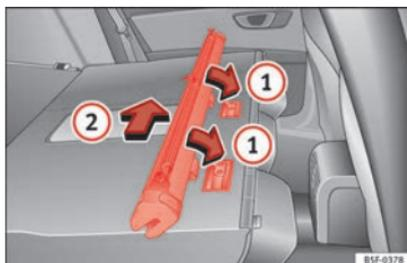
**Abb. 173** Einbau der Netztrennwand an den Rücksitzlehnen
