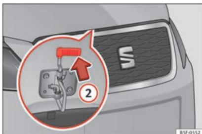
Abb. 9 Hebel unter der Motorraumklappe.
