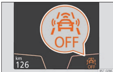
Abb. 271 Am Bildschirm des Kombi-Instruments: Anzeige, dass Front Assist ausgeschaltet ist.
