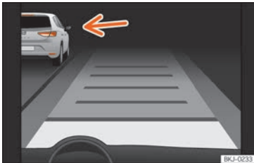
Abb. 278 Am Bildschirm des Kombi-Instruments: ACC aktiv, Fahrzeug auf der linken Seite erkannt
