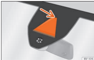
Abb. 281 An der Windschutzscheibe: Kamerasichtfenster des Spurhalteassistenten.
