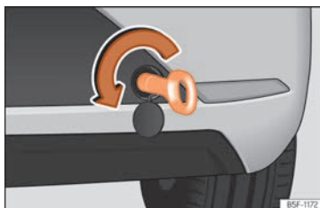
Abb. 50 Stoßfänger hinten rechts: eingeschraubte Abschleppöse.
