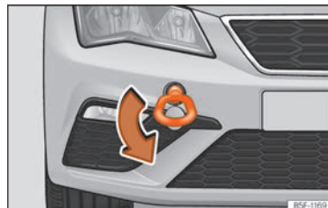
Abb. 48 Stoßfänger vorn rechts: eingeschraubte Abschleppöse.
