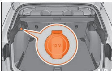
Abb. 168 Detail an der Seitenverkleidung des Gepäckraums: 12-Volt-Steckdose (gilt nur für das Modell Leon Sportourer ST).
