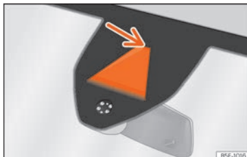
Abb. 277 Kamerasichtfenster des Spurhalteassistenten.
