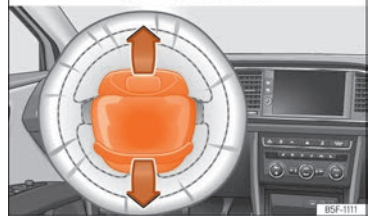
Abb. 26 Einbauort Fahrerairbag: im Lenkrad. »
