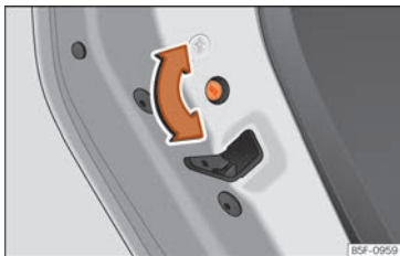
Abb. 147 Kindersicherung in der linken Tür
