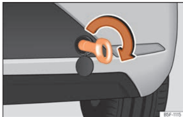
Abb. 81 Hinterer Stoßfänger rechts: Eingeschraubte Abschleppöse
