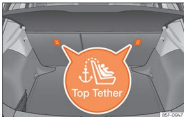
Abb. 41 Lage der Top Tether-Ösen im hinteren Teil des Rücksitzes
