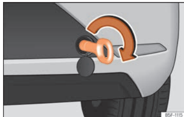
Abb. 103 Hinterer Stoßfänger rechts: Eingeschraubte Abschleppöse
