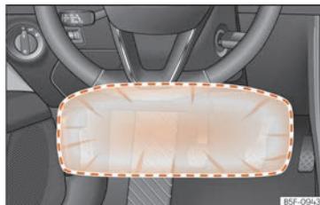
Abb. 31 Auf der Fahrerseite: Wirkungsbereich des Knieairbags.
