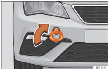
Abb. 101 Vorderer Stoßfänger rechts: Eingeschraubte Abschleppöse
