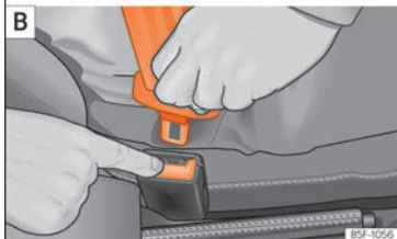
Abb. 96 Schliessung des Sicherheitsgurts in das Gurtschloss einstecken und vom Gurtschloss lösen.
