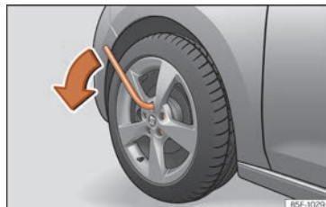
Abb. 77 Rad: Radschrauben lockern.
