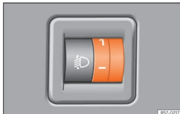
Abb. 153 Neben dem Lenkrad: Regler für die Leuchtweitenregulierung.
