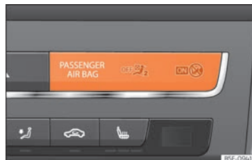
Abb. 99 Instrumententafel: Kontrollleuchte für abgeschalteten Beifahrerairbag.
