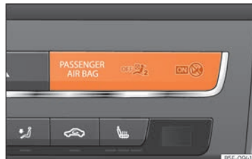
Abb. 29 Instrumententafel: Kontrollleuchte für abgeschalteten Beifahrerairbag.
