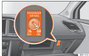
Abb. 98 Schlüsselschalter zum Ein- und Abschalten des Beifahrerairbags.
