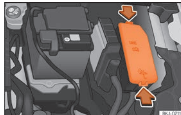
Abb. 161 Im Motorraum: Abdeckung des Sicherungskastens.
