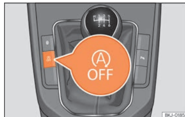
Abb. 88 Mittelkonsole: Systemtaste Start-Stop.
