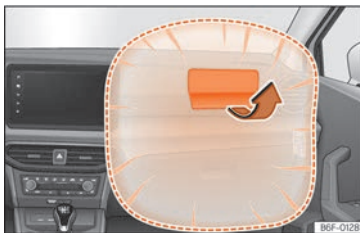
Abb. 29 Beifahrerairbag in der Instrumententafel
