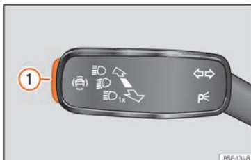
Abb. 95 Am Blinker- und Fernlichthebel: Taste für die Fahrerassistenzsysteme (modellabhängig).
