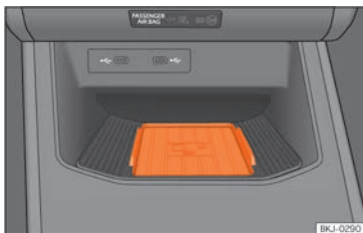
Abb. 136 In der Mittelkonsole: Aufnahme für die Mobiltelefonkopplung.
