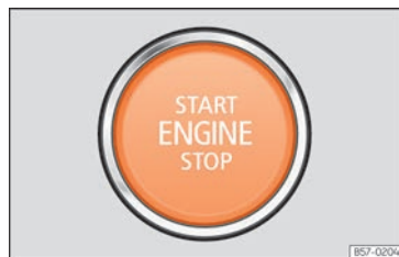
Abb. 86 Im unteren Bereich der Mittelkonsole: Starterknopf.
