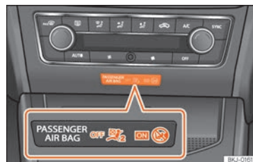
Abb. 31 Instrumententafel-Mittelteil: Kontrollleuchte für abgeschalteten Beifahrer-Frontairbag.
