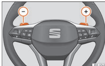
Abb. 92 Lenkrad: die Hebel für Automatikgetriebe.
