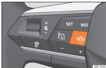
Abb. 96 Linke Seite des Multifunktionslenkrs: Taste für die Fahrerassistenzsysteme (modellabhängig).
