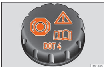
Abb. 174 Motorraum: Deckel des Bremsflüssigkeitsbehälters
