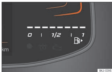
Abb. 5 Kombi-Instrument Basic: Kraftstoffvorratsanzeige.
