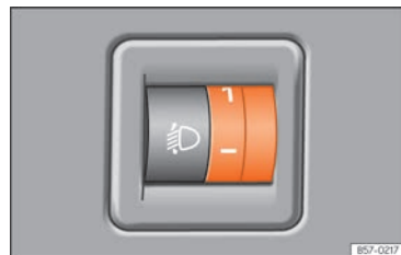
Abb. 75 Neben dem Lenkrad: Regler für die Leuchtweitenregulierung.
