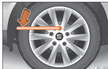
Abb. 36 Radwechsel: Radschrauben lockern.
