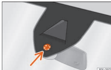
Abb. 106 Sensitive Fläche des Regensensors.
