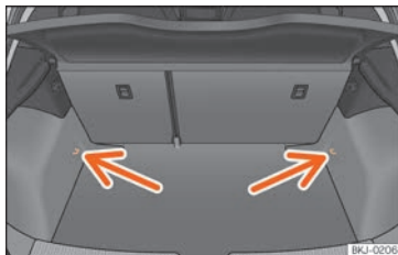
Abb. 130 Anordnung der Verzurrösen im Gepäckraum.
