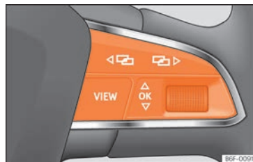
Abb. 78 Rechte Seite des Multifunktionslenkrads: Bedienelemente für die Menüs und Informationsanzeige im Kombi-Instrument.
