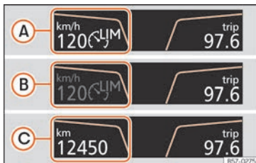
Abb. 225 Am Bildschirm des Kombi-Instruments: Statusanzeigen des Geschwindigkeitsbegrenzers.
