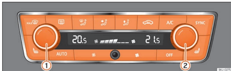
Abb. 138 In der Mittelkonsole: Bedienungselemente der Climatronic.
