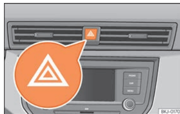
Abb. 109 Instrumententafel: Schalter für Warnblinkanlage.
