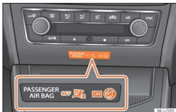
Abb. 18 In der Mitte der Instrumententafel: Kontrollleuchte für Abschaltung der Beifahrerairbags.
