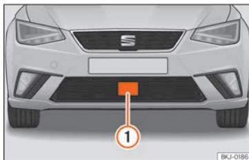
Abb. 229 Am vorderen Stoßfänger: Radarsensor.
