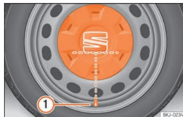
Abb. 34 Korrekte Anbringung der Radvollblende für Stahlfelgen.
