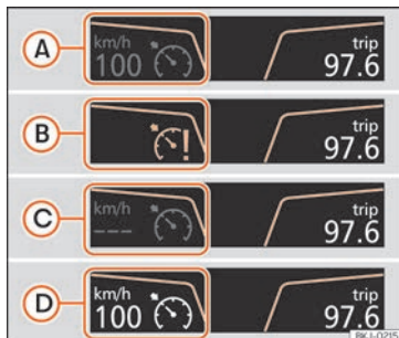
Abb. 222 Bildschirm des Kombi-Instruments: Zustandsanzeigen der GRA.
