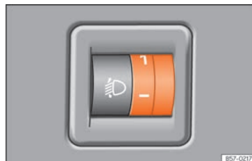
Abb. 110 Neben dem Lenkrad: Regler für die Leuchtweitenregulierung.
