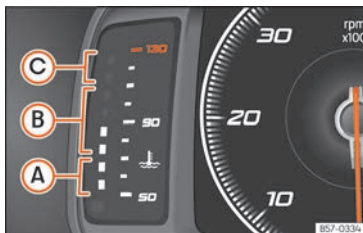
Abb. 76 Frei konfigurierbares Kombiinstrument: Motorkühlmittel-Temperaturanzeige.
