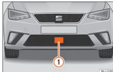
Abb. 235 Am vorderen Stoßfänger: Radarsensor.
