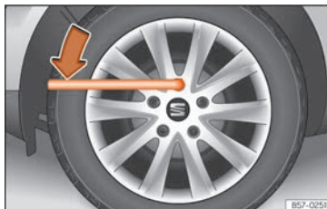
Abb. 38 Radwechsel: Radschrauben lockern.
