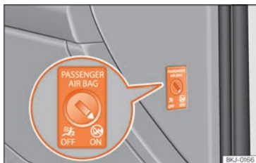
Abb. 17 Schlüsselschalter zum Ein- und Abschalten des Beifahrerairbags.
