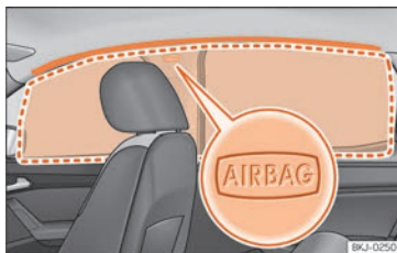
Abb. 21 Einbauort und Entfaltungsbereich des Kopfairbags.
