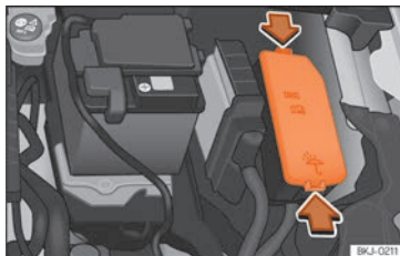
Abb. 52 Im Motorraum: Abdeckung des Sicherungskastens.
