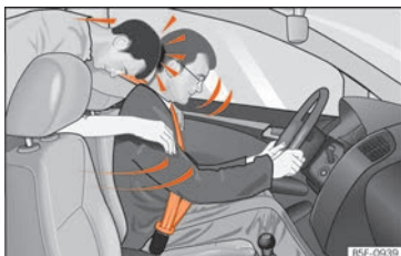
Abb. 9 Der nicht angegurte Mitfahrer auf dem Rücksitz schleudert nach vorn auf den angegurten Fahrer.
