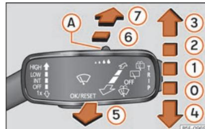
**Abb. 46** Bedienung von Windschutz- und Heckscheibenwischer
