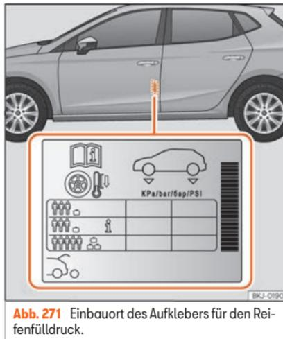
Abb. 271 Einbauort des Aufklebers für den Reifenfülldruck.
