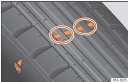
Abb. 272 Reifenprofil-Verschleißanzeiger
