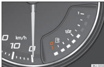
Abb. 120 Analoges Kombiinstrument: Kraftstoffvorratsanzeige
