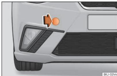
**Abb. 99** Vorderer Stoßfänger, rechte Seite: Abdeckung abziehen.
