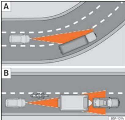
**Abb. 241** (A) Fahrzeug in einer Kurve. (B) Vorausfahrender Motorradfahrer außerhalb des Erfassungsbereichs des Radarsensors.
