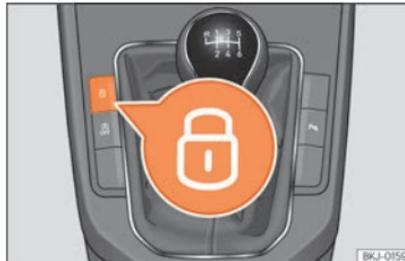
Abb. 5 Mittelkonsole: Zentralverriegelungstaster.
