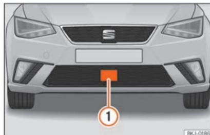
**Abb. 232** Im vorderen Stoßfänger: Radarsensor.
