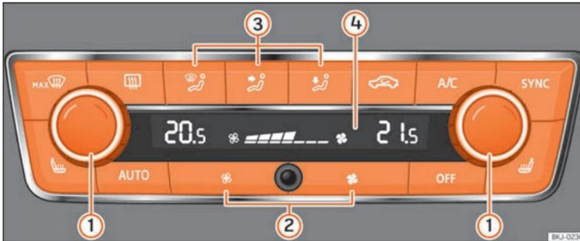
**Abb. 56** In der Mittelkonsole: Bedienelemente der Climatronic.
