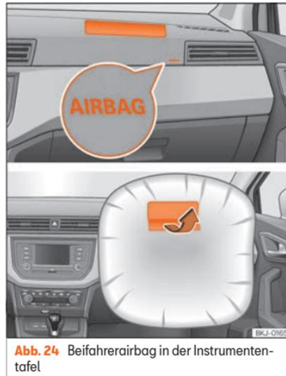
**Abb. 24** Beifahrerairbag in der Instrumententafel
