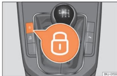
Abb. 134 Taster für Zentralverriegelung
