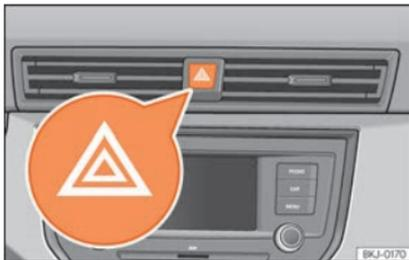
**Abb. 44** Instrumententafel: Schalter für die Warnblinkanlage
