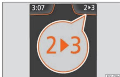
Abb. 224 Kombi-Instrument: Ganganzeige (Handgetriebe).
