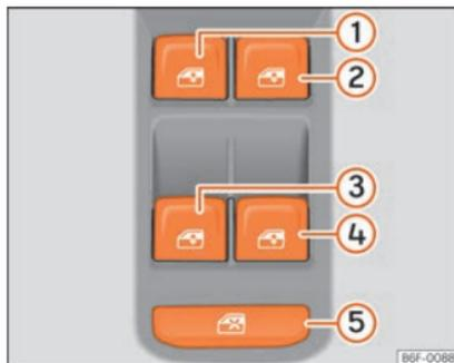
**Abb. 140** Ausschnitt aus der Fahrertür: Bedienelemente für die vorderen und hinteren Fenster (Fahrzeug mit elektrischen Fensterhebern vorne und hinten).
