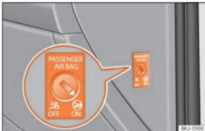
Abb. 25 Schalter für Beifahrer-Frontairbag.
