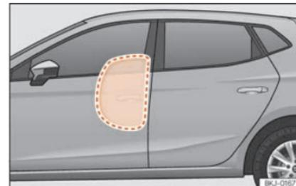
Abb. 28 Komplettaufgeblasener Seitenairbag auf der linken Fahrzeugseite.
