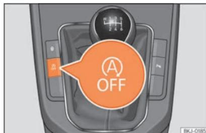
**Abb. 226** Mittelkonsole: Systemtaste Start-Stopp.
