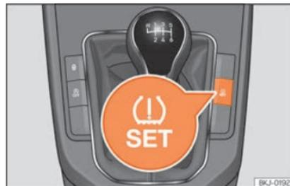
Abb. 274 Mittelkonsole: Taste für die Reifenkontrollanzeige
