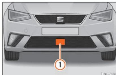
**Abb. 237** Im vorderen Stoßfänger: Radarsensor.
