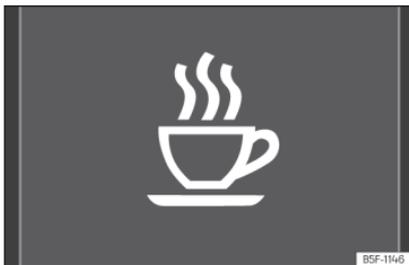
**Abb. 119** Im Display des Kombiinstruments: Symbol der Müdigkeitserkennung.
