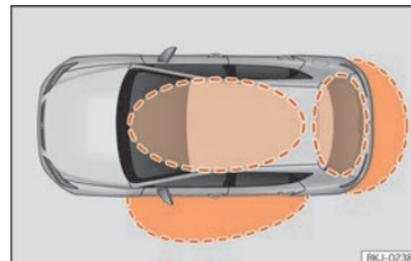
**Abb. 137** Schlüsselloses Schließ- und Startsystem Keyless Access: Näherungsbereiche.
