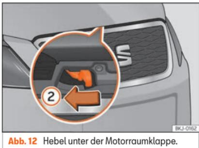
Abb. 12 Hebel unter der Motorraumklappe.
