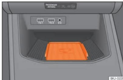
**Abb. 215** Mittelkonsole: Connectivity Box
