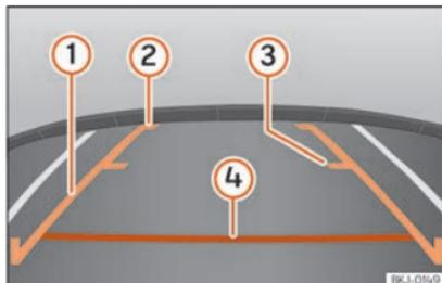
Abb. 250 Anzeigen im Display des Infotainmentsystems: Orientierungslinien.
