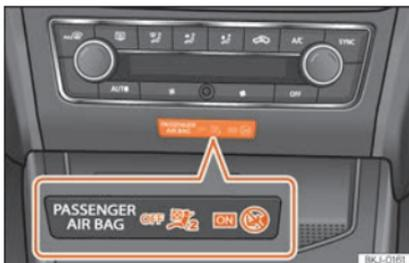
Abb. 26 Instrumententafel-Mittelteil: Kontrollleuchte für abgeschalteten Beifahrer-Frontairbag.
