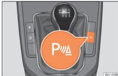
**Abb. 245** Mittelkonsole: Taste für Einparkhilfe (je nach Ausführung).
