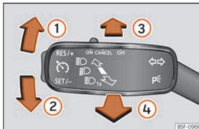
Abb. 43 Blinker- und Fernlichthebel.
