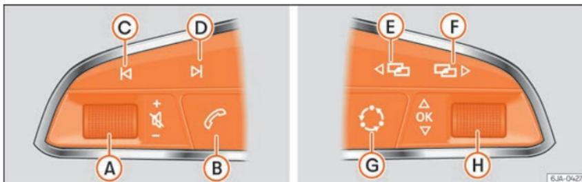
Abb. 128 Bedienelemente am Lenkrad
