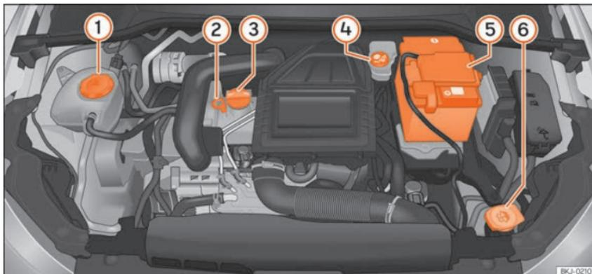
**Abb. 269** Abbildung für die Einbaustellen der Elemente
