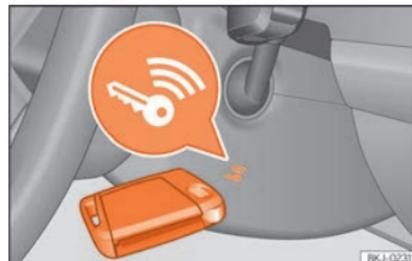
**Abb. 218** Rechts an der Lenksäule: Notstart.
