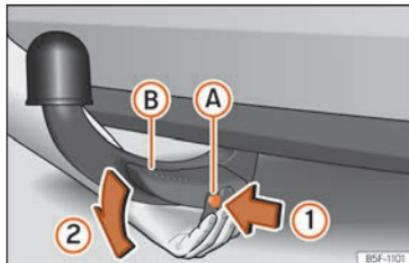
Abb. 261 Abnehmbaren Kugelkopf lösen
