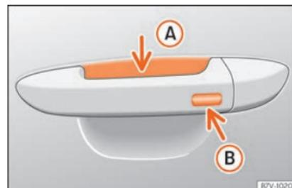
**Abb. 138** Schlüsselloses Schließ- und Startsystem Keyless Access: Sensorfläche **A** zur Entriegelung auf der Innenseite des Türgriffs und Sensorfläche **B** zur Verriegelung auf der Außenseite des Türgriffs.
