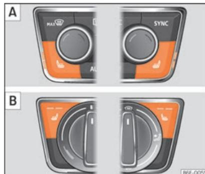
**Abb. 151** In der Mittelkonsole: Regler für die Sitzheizung der Vordersitze. |A|: Ausführung mit Climatronik. |B|: Ausführung mit manueller Klimaanlage.
