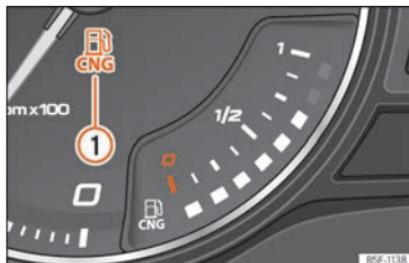
Abb. 122 Analoges Kombiinstrument: Erdgasvorratsanzeige
