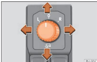
**Abb. 20** Ausschnitt der Fahrertür: Außenspiegelbedienung.
