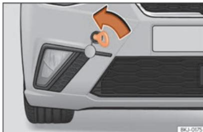
**Abb. 100** Vorderer Stoßfänger rechts: Eingeschraubte Abschleppöse
