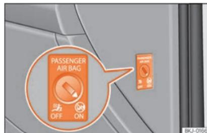
**Abb. 96** Schlüsselschalter zum Ein- und Abschalten des Beifahrerairbags.
