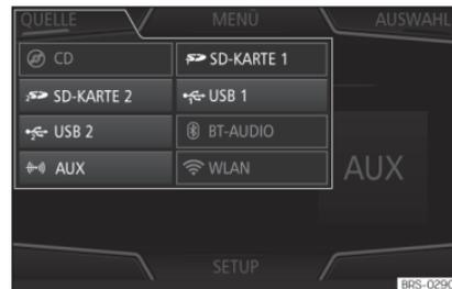
**Abb. 197** MEDIA-Betrieb: Mediaquelle wechseln.
