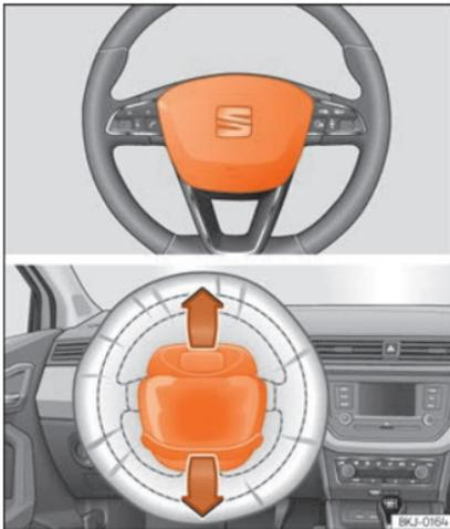
**Abb. 23** Einbauort Fahrerairbag: im Lenkrad.
