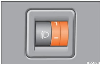
**Abb. 145** Instrumententafel: Regler für Leuchtweitenregulierung.
