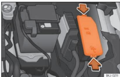
**Abb. 65** Im Motorraum: Abdeckung des Sicherungskastens.
