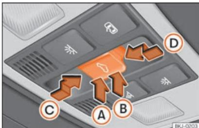
**Abb. 14** Im Dachhimmel: Bedienelement für Panorama-Schiebedach.
