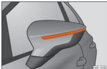
Abb. 110 Blinker im Rückspiegel integriert
