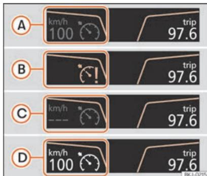
**Abb. 227** Display des Kombiinstrument: Zustandsanzeigen der GRA.
