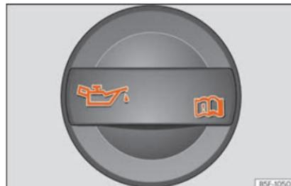
**Abb. 60** Deckel der Motoröl-Einfüllöffnung im Motorraum
