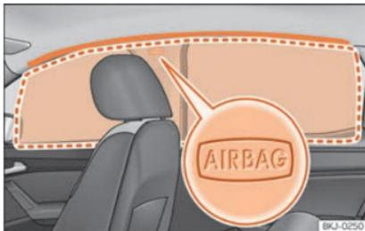
**Abb. 29** Einbauort und Entfaltungsbereich des Kopfairbags.
