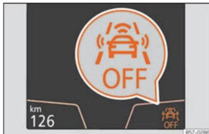
**Abb. 233** Auf dem Display des Kombi-Instruments: Anzeige, dass Front Assist ausgeschaltet ist.
