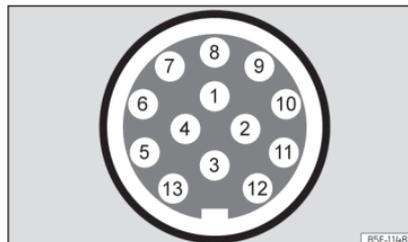
**Abb. 262** Schematische Darstellung: Zuweisung der Steckverbinderstifte für Anhängerstrom.
