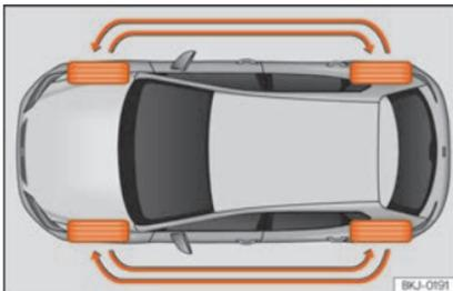
Abb. 273 Schema für das Tauschen der Räder.
