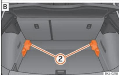
**Abb. 166** Variabler Gepäckraumboden: **A** Hochstellung; **B** Tiefstellung.
