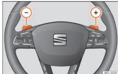
Abb. 223 Lenkrad: die Hebel für Automatikgetriebe.
