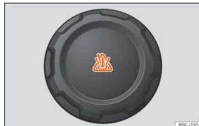
**Abb. 61** Motorraum: Deckel des Motorkühlmittelausgleichsbehälters
