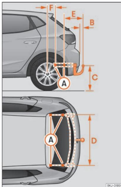
Abb. 264 Befestigungspunkte für die Anhängervorrichtung
