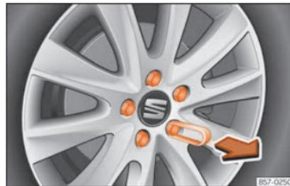
**Abb. 73** Rad: Radschrauben mit Deckel.
