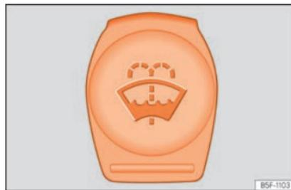
**Abb. 63** Im Motorraum: Deckel des Scheibenwaschbehälters.
