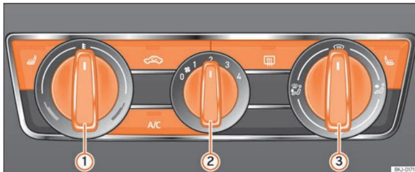
**Abb. 171** Bedienelemente Klimaanlage in der Instrumententafel.
