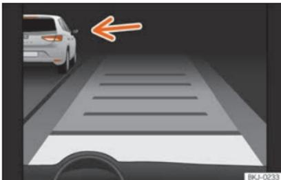
**Abb. 240** Im Display des Kombiinstrument: ACC aktiv, Fahrzeug auf der linken Seite erkannt
