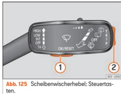
**Abb. 125** Scheibenwischerhebel: Steuertasten.
