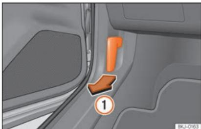
Abb. 11 Entriegelungshebel im Fahrerfußraum.
