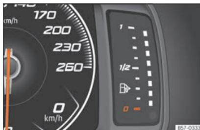
Abb. 121 Frei konfigurierbares Kombiinstrument: Kraftstoffvorratsanzeige.
