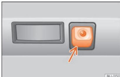
**Abb. 249** Im Stoßfänger hinten: Einbauort der Rückfahrkamera.
