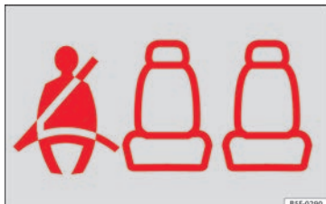
Abb. 97 Kombi-Instrument: Anzeige, dass der Platz hinten rechts besetzt und der entsprechende Sicherheitsgurt angelegt ist.
