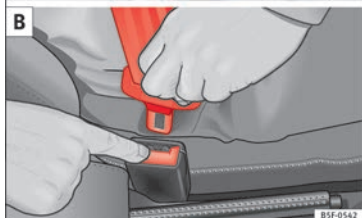
Abb. 101 Schlosszunge des Sicherheitsgurts in das Gurtschloss einstecken und vom Gurtschloss lösen.
