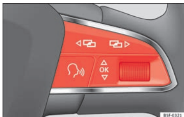
Abb. 46 Rechte Seite Multifunktions-Lenkrad: Steuertasten.
