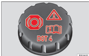
Abb. 67 Motorraum: Deckel des Bremsflüssigkeitsbehälters
