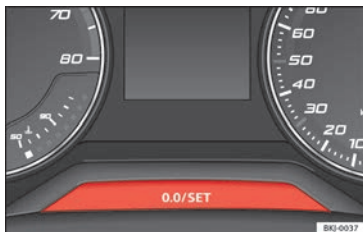
Abb. 122 Kombi-Instrument: Kilometerzähler und Rücksteltaste.
