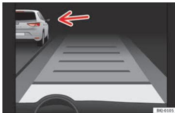
Abb. 195 Im Display des Kombiinstrument: ACC aktiv, Fahrzeug auf der linken Seite erkannt
