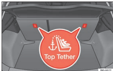
Abb. 34 Lage der Top Tether-Ösen im hinteren Teil des Rücksitzes
