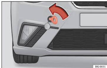
Abb. 85 Vorderer Stoßfänger, rechte Seite: Abschleppöse.
