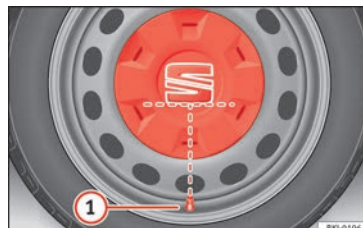
Abb. 76 Korrekte Anbringung der Radvollblende für Stahlfelgen.
