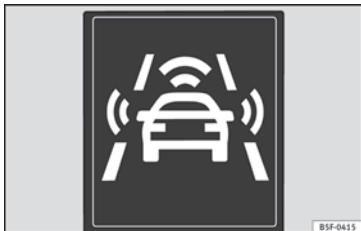
Abb. 187 Im Display des Kombiinstrumentes: Anzeige der Vorwarnung.
