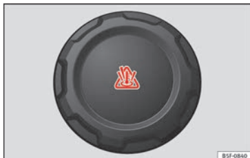
Abb. 66 Motorraum: Deckel des Motorkühlmittelausgleichsbehälters
