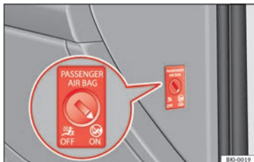
Abb. 103 Schlüsselschalter zum Ein- und Abschalten des Beifahrerairbags.
