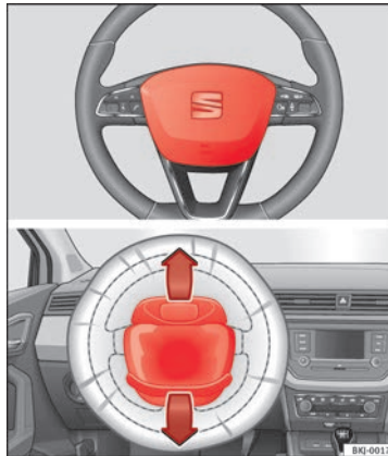
Abb. 21 Einbauort Fahrerairbag: im Lenkrad.
