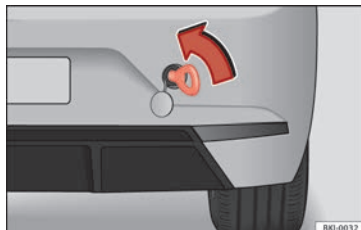
Abb. 86 Hinterer Stoßfänger, rechte Seite: Abschleppöse.
