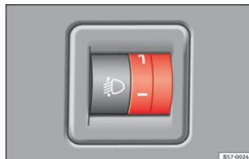
Abb. 144 Instrumententafel: Regler für Leuchtweitenregulierung.
