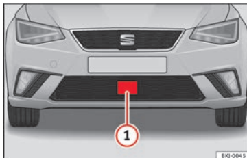
Abb. 185 Im vorderen Stoßfänger: Radarsensor.
