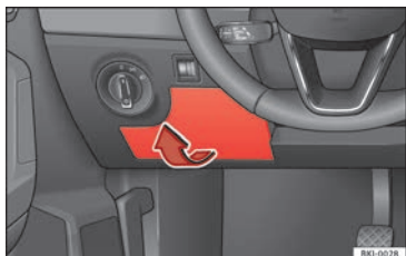
Abb. 69 Auf der Fahrerseite in der Instrumententafel: Abdeckung des Sicherungskastens.
