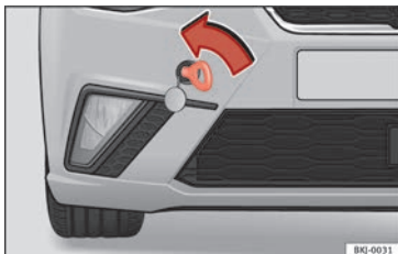
Abb. 106 Vorderer Stoßfänger rechts: Eingeschraubte Abschleppöse
