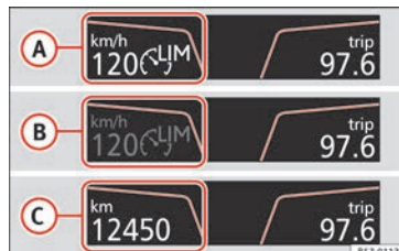
Abb. 181 Im Display des Kombiinstrument: Anzeige des Zustands des Geschwindigkeitsbegrenzers.
