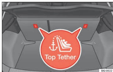
Abb. 32 Lage der Top Tether-Ösen im hinteren Teil des Rücksitzes
