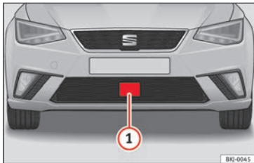
Abb. 192 Im vorderen Stoßfänger: Radarsensor.
