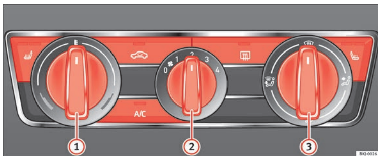
Abb. 61 In der Mittelkonsole: Bedienelemente der manuellen Klimaanlage.
