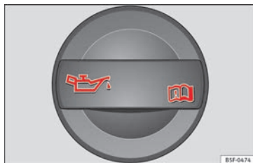
Abb. 65 Deckel der Motoröl-Einfüllöffnung im Motorraum
