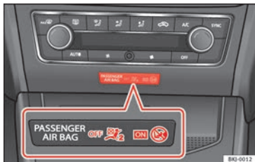
Abb. 104 Instrumententafel-Mittelteil: Kontrollleuchte für abgeschalteten Beifahrer-Frontairbag.
