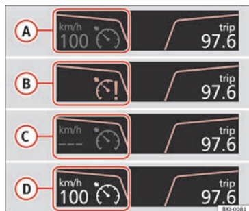
Abb. 180 Display des Kombiinstrument: Zustandsanzeigen der GRA.
