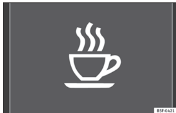
Abb. 200 Im Display des Kombiinstrumentes: Symbol der Müdigkeitserkennung.
