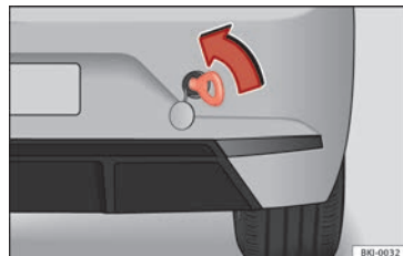
Abb. 108 Hinterer Stoßfänger rechts: Eingeschraubte Abschleppöse
