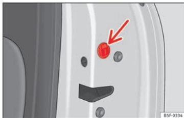
Abb. 5 Notfallsperre der Tür.
