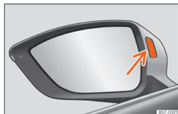
Abb. 127 Kontrollleuchte des Spurwechselassistenten.
