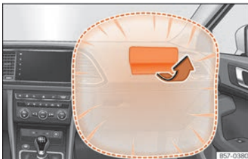
Abb. 15 Beifahrerairbag in der Instrumententafel
