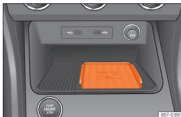
Abb. 145 In der Mittelkonsole: Aufnahme für die Mobiltelefonkopplung.
