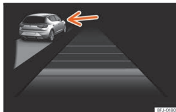
Abb. 170 Am Bildschirm des Kombi-Instruments: ACC aktiv, Fahrzeug auf der linken Seite erkannt
