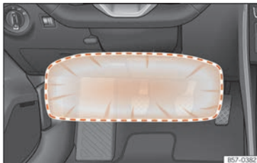
Abb. 19 Auf der Fahrerseite: Wirkungsbereich des Knieairbags.
