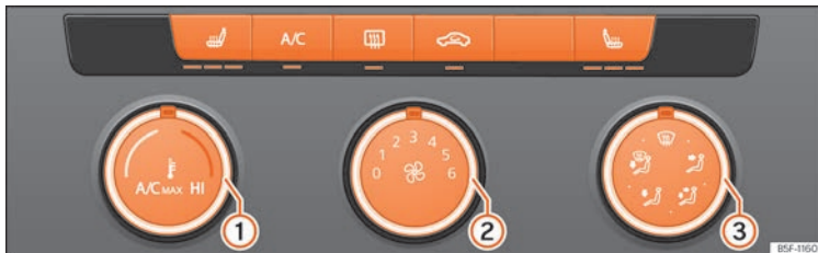
Abb. 135 In der Mittelkonsole: Bedienungselemente für die Klimaanlage.
