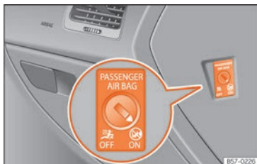
Abb. 16 Schlüsselschalter zum Ein- und Abschalten des Beifahrerairbags.
