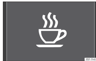
Abb. 56 Am Bildschirm des Kombi-Instruments: Symbol für Müdigkeitserkennung.
