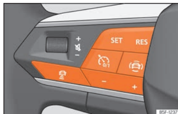
Abb. 168 Am Multifunktionslenkrad: Tasten zur ACC-Bedienung
