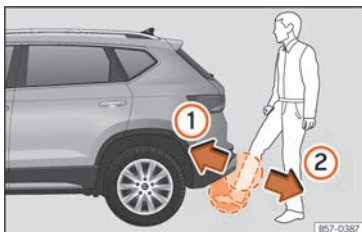
Abb. 89 Heckklappe mit sensorgesteuerter Öffnung (Easy Open).
