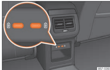
Abb. 147 Mittelkonsole hinten: USB-Anschlüsse mit Steckdosenfunktion.
