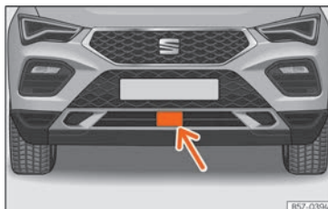
Abb. 157 Am vorderen Stoßfänger: Radarsensor.
