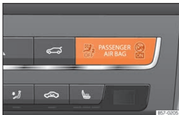
Abb. 17 Instrumententafel: Kontrollleuchte für Abschaltung des Beifahrerairbags.
