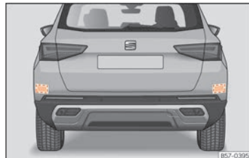
Abb. 160 Heckansicht des Fahrzeugs: Bereiche der Radarsensoren.
