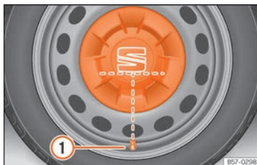
Abb. 33 Korrekte Anbringung der Radvollblende für Stahlfelgen.
