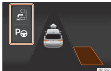
Abb. 185 Am Bildschirm des Kombi-Instruments: Anzeige des Parklenkassistenten mit eingeschränkter Sicht.
