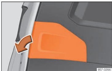
Abb. 61 Offene Heckklappe: Abdeckung entfernen.
