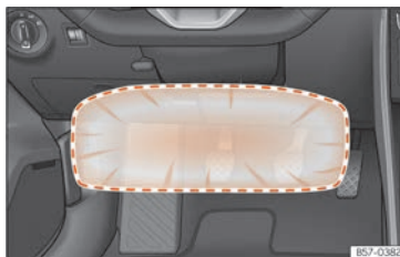
Abb. 19 Auf der Fahrerseite: Wirkungsbereich des Knieairbags.
