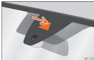
Abb. 168 An der Windschutzscheibe: Kamera-sichtfenster des Spurhalteassistenten.
