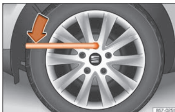
Abb. 36 Radwechsel: Radschrauben lockern.
