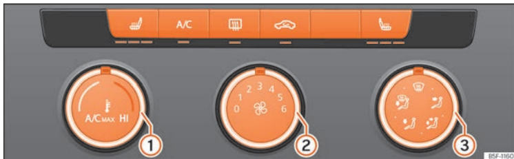
Abb. 146 In der Mittelkonsole: Bedienungselemente für die Klimaanlage.
