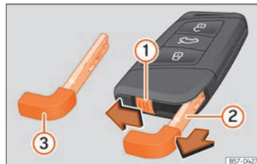
Abb. 86 Fahrzeugschlüssel: Notschlüssel abziehen.
