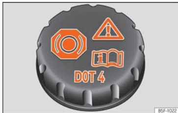
Abb. 225 Motorraum: Deckel des Bremsflüssigkeitsbehälters.
