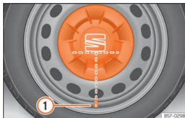
Abb. 33 Korrekte Anbringung der Radvollblende für Stahlfelgen.
