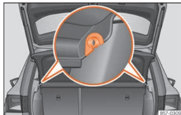
Abb. 127 Im Gepäckraum: Gepäckraumabdeckung aus- und einbauen.
