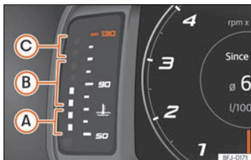
Abb. 74 Frei konfigurierbares Kombi-Instrument: Motorkühlmittel-Temperaturanzeige.
