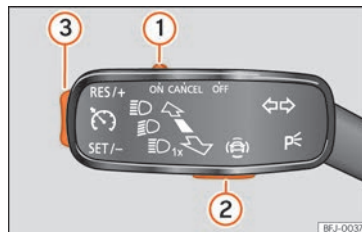
Abb. 175 Am Blinkerhebel: Tasten zur Bedienung des Geschwindigkeitsbegrenzers.
