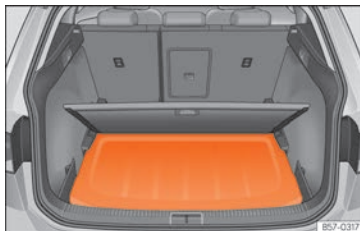
Abb. 129 Im Gepäckraum: Einsetzen der Gepäckraumabdeckung.
