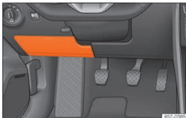
Abb. 49 Linklenker: Abdeckung des Sicherungskasten unter der Instrumententafel auf der Fahrerseite
