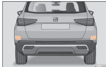
Abb. 169 Heckansicht des Fahrzeugs: Bereiche der Radarsensoren.
