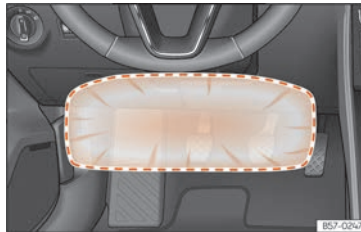
Abb. 31 Auf der Fahrerseite: Wirkungsbereich des Knieairbags.
