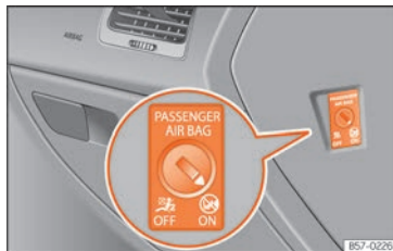
Abb. 28 Schalter für Beifahrer-Frontairbag.
