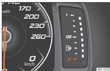
Abb. 129 Frei konfigurierbares Kombiinstrument: Kraftstoffvorratsanzeige.
