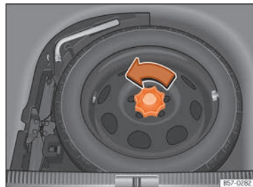
Abb. 310 Notrad: hochgeklappter Ladeboden
