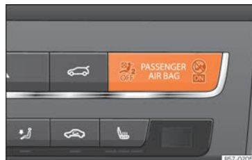
Abb. 29 Instrumententafel: Kontrollleuchte für abgeschalteten Beifahrerairbag.
