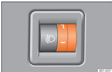
Abb. 154 Neben dem Lenkrad: Regler für die Leuchtweitenregulierung.
