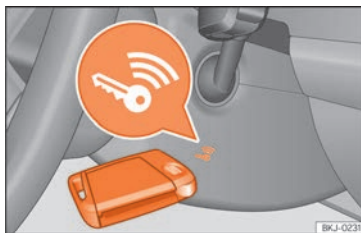
Abb. 242 Rechts an der Lenksäule: Notstart.
