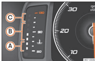
Abb. 131 Frei konfigurierbares Kombiinstrument: Motor Kühlmitteltemperatur-Anzeige.
