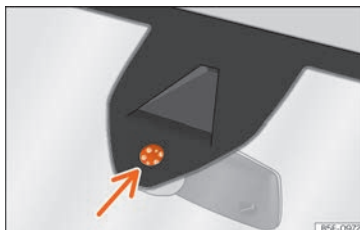
Abb. 186 Feuchtigkeits- und Temperatursensor der Windschutzscheibe.
