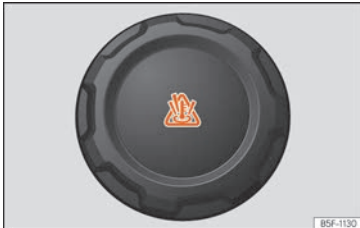
Abb. 64 Motorraum: Deckel des Motorkühlmittelbehälters
