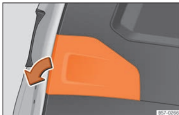
Abb. 116 Geöffnete Heckklappe: Abdeckung entfernen.
