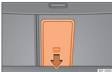
Abb. 175 Im Gepäckraum: Öffnung der Durchladeeinrichtung.
