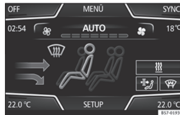
Abb. 183 Display Easy Connect: Menü Klimaanlage.
