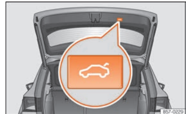
Abb. 9 Heckklappe: Taste zum Schließen der Heckklappe.
