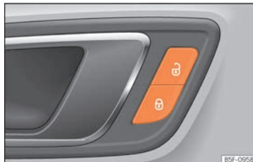
Abb. 5 Fahrertür: Taste Zentralverriegelung.
