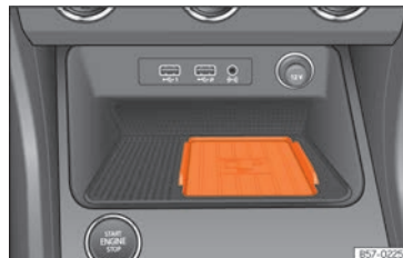
Abb. 239 In der Mittelkonsole: Aufnahme für die Mobiltelefonkopplung.
