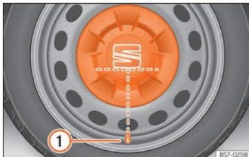
Abb. 74 Korrekte Anbringung der Radvollblende für Stahlfelgen.
