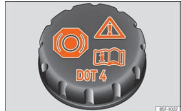
Abb. 65 Motorraum: Deckel des Bremsflüssigkeitsbehälters
