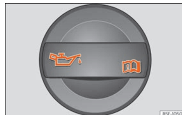
Abb. 63 Deckel der Motoröl-Einfüllöffnung im Motorraum
