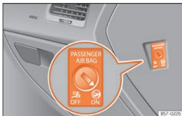
Abb. 98 Schlüsselschalter zum Ein- und Abschalten des Beifahrerairbags.
