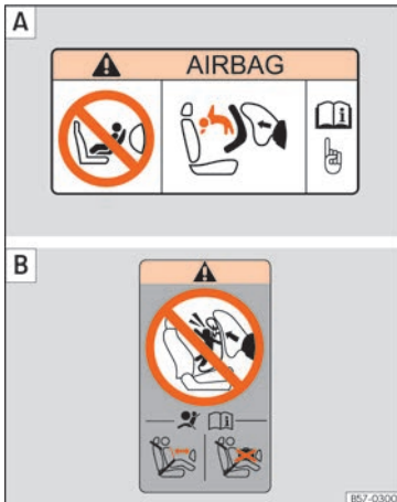
Abb. 37 Airbagaufkleber - Version 2: an der Beifahrer-Sonnenblende [A] und am hinteren Türrahmen des Beifahrers [B].
