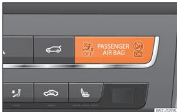
Abb. 99 Instrumententafel: Kontrollleuchte für abgeschalteten Beifahrerairbag.
