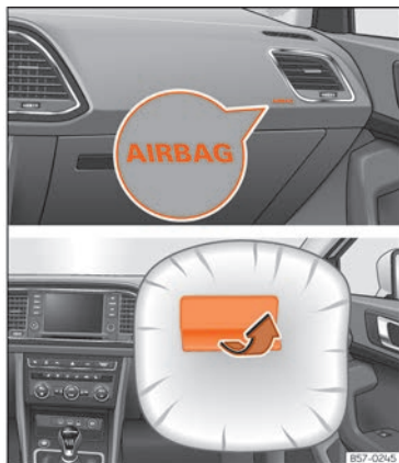
Abb. 27 Beifahrerairbag in der Instrumententafel
