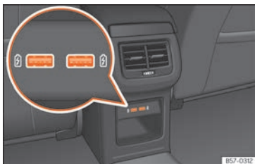
Abb. 237 Mittelkonsole hinten: USB-Anschlüsse.
