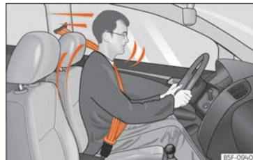
Abb. 93 Richtig angelegte Fahrer werden bei einem plötzlichen Bremsmanöver nicht nach vorne geschleudert.
