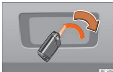
Abb. 11 Ausschnitt Gepäckraum: Notfallentriegelung.
