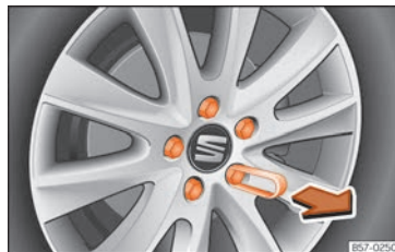
Abb. 75 Rad: Radschrauben mit Deckel.
