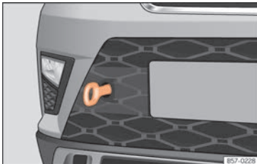
Abb. 80 Vorderer Stoßfänger rechts: Eingeschraubte Abschleppöse
