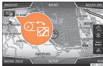
Abb. 125 Infotainment-System: Taste zur Kartenübertragung
