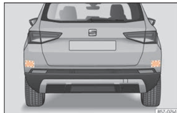
Abb. 272 Bereich hinter dem Fahrzeug: Bereiche der Radarsensoren.
