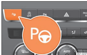
Abb. 279 In der Mittelkonsole oben: Taster für Parklenkassistent.
