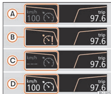
Abb. 250 Display des Kombiinstrument: Zustandsanzeigen der GRA.
