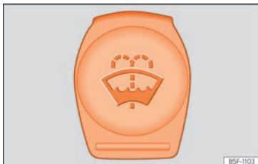
Abb. 66 Im Motorraum: Deckel des Scheibenwaschbehälters.
