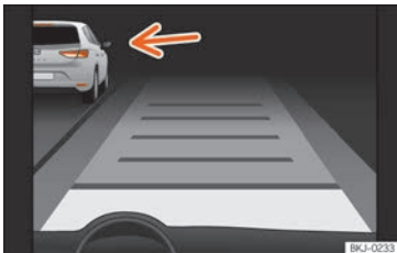
Abb. 263 Im Display des Kombiinstrumentes: ACC aktiv, Fahrzeug auf der linken Seite erkannt
