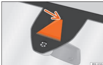
Abb. 266 Kamerasichtfenster des Spurhalteassistenten.
