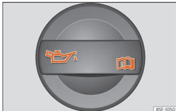
Abb. 305 Deckel der Motoröl-Einflöföffnung im Motorraum
