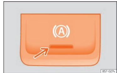
Abb. 249 Im unteren Bereich der Mittelkonsole: Funktionstaste Auto-Hold.
