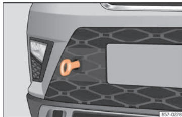
Abb. 102 Auf der rechten Seite des vorderen Stoßfängers: Eingeschraubte Abschleppöse.
