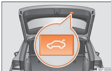
Abb. 145 Heckklappe geöffnet: Taste für das sofortige Schließen der Heckklappe.
