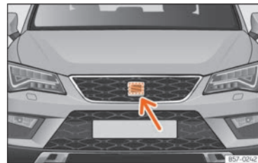
Abb. 260 Im Frontbereich hinter dem SEAT-Emblem: Radarsensor.
