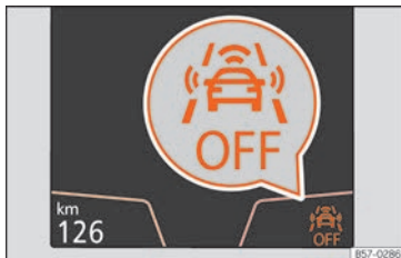
Abb. 256 Auf dem Display des Kombi-Instruments: Anzeige, dass Front Assist ausgeschaltet ist.
