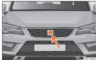
Abb. 255 Im Frontbereich hinter dem SEAT-Emblem: Radarsensor.
