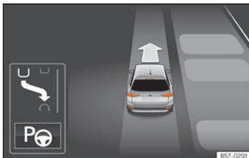
Abb. 281 Am Bildschirm des Kombi-Instruments: Anzeige des Parklenkassistenten mit eingeschränkter Sicht.
