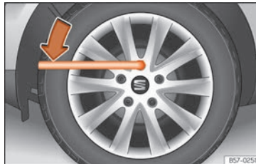
Abb. 77 Rad: Radschrauben lockern.
