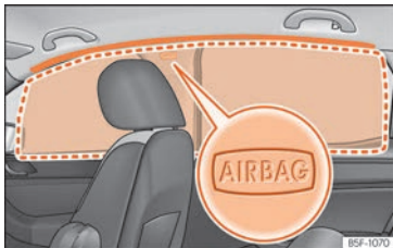
Abb. 34 Einbauort der Kopfairbags
