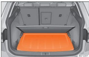
Abb. 173 Im Gepäckraum: Einsetzen der Gepäckraumabdeckung.
