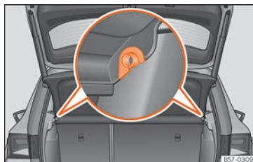
Abb. 171 Im Gepäckraum: Gepäckraumabdeckung aus- und einbauen.
