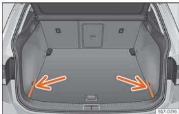
Abb. 172 Im Gepäckraum: Abdeckungen zum Verstauen der Gepäckraumabdeckung.
