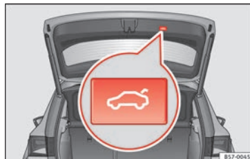
Abb. 133 Gepäckraumklappe geöffnet: Taste zum sofortigen Schließen der Gepäckraumklappe
