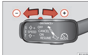
Abb. 189 Bedienhebel: Abstand einstellen.
