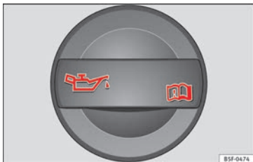
Abb. 236 Deckel der Motoröl-Einfüllöffnung im Motorraum
