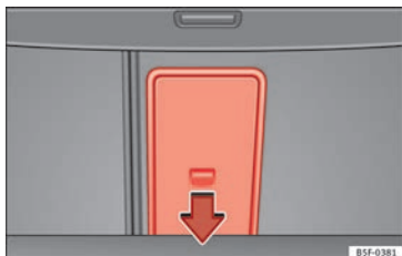
Abb. 159 Im Gepäckraum: Öffnung der Durchladeeinrichtung.
