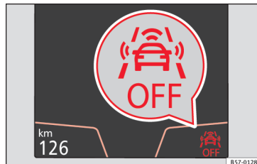
Abb. 194 Auf dem Display des Kombi-Instrumentes: Anzeige, dass Front Assist ausgeschaltet ist.
