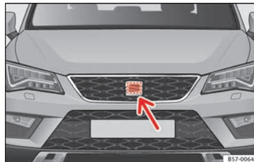
Abb. 193 Im Frontbereich hinter dem SEAT-Emblem: Radarsensor.
