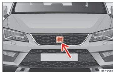
Abb. 185 Im Frontbereich hinter dem SEAT-Emblem: Radarsensor.
