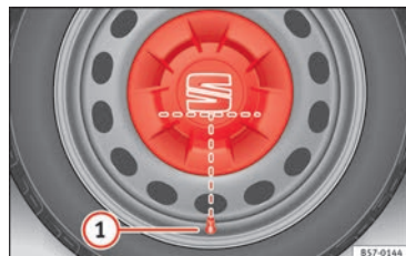
Abb. 69 Korrekte Anbringung der Radvollblende für Stahlfelgen.
