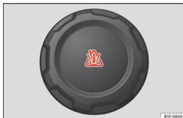
Abb. 61 Motorraum: Deckel des Motorkühlmittelausgleichsbehälters
