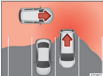
Abb. 206 Schematische Abbildung des Ausparkassistenten: Überwachter Bereich des ausparkenden Fahrzeugs.
