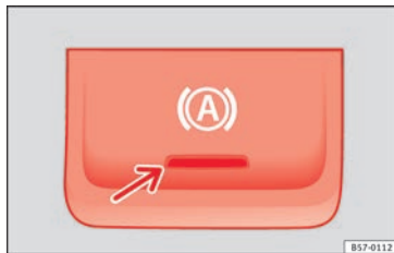
Abb. 177 Im unteren Bereich der Mittelkonsole: Funktionstaste Auto-Hold.
