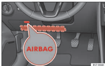
Abb. 23 Auf der Fahrerseite: Einbauort des Knieairbags.
