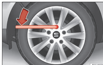
Abb. 72 Rad: Radschrauben lockern.
