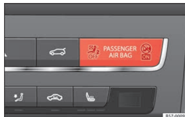
Abb. 93 Kontrollleuchte in der Instrumententafel für abgeschalteten Beifahrer-Frontairbag.
