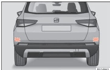
Abb. 203 Bereich hinter dem Fahrzeug: Bereiche der Radarsensoren.
