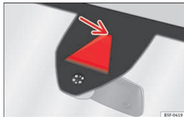
Abb. 199 Kamerasichtfenster des Spurhalteassistenten.
