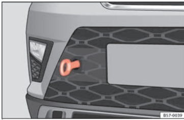
Abb. 75 Vorderer Stoßfänger rechts: Eingeschraubte Abschleppöse
