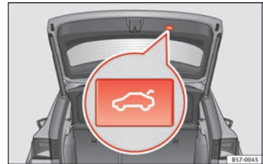
Abb. 6 Heckklappe: Taste zum Schließen der Heckklappe.
