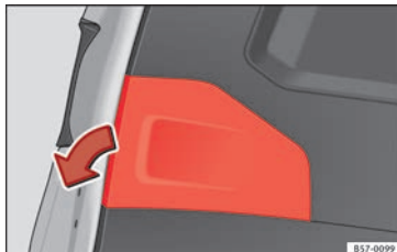
Abb. 112 Gepäckraumklappe geöffnet: Abdeckung entfernen.
