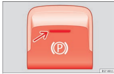
Abb. 172 Im unteren Bereich der Mittelkonsole: Taste für die elektronische Parkbremse. »
