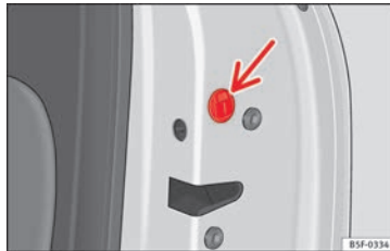
Abb. 4 Notfallsperre der Tür.
