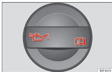
Abb. 60 Deckel der Motoröl-Einfüllöffnung im Motorraum
