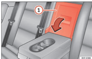
Abb. 158 An der Rücksitzlehne: Öffnung der Durchladeeinrichtung.
