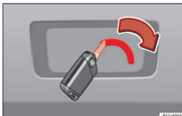
Abb. 8 Ausschnitt Gepäckraum: Notfallentriegelung.
