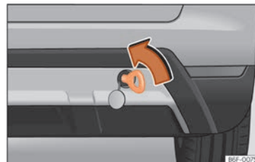
Abb. 49 Auf der rechten Seite des hinteren Stoßfängers: eingeschraubte Abschleppöse.
