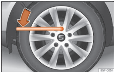
Abb. 37 Radwechsel: Radschrauben lockern.
