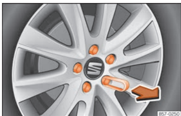
Abb. 35 Rad: Radschrauben mit Deckel.
