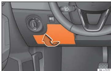
Abb. 50 Auf der Fahrerseite in der Instrumententafel: Abdeckung des Sicherungskastens.
