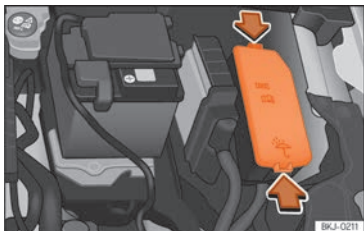
Abb. 51 Im Motorraum: Abdeckung des Sicherungskasten.
