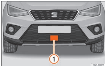
Abb. 234 Am vorderen Stoßfänger: Radarsensor.
