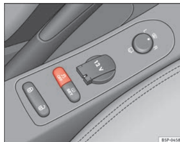
Abb. 138 Ansicht der Mittelkonsole: Taste ESC (ESP)
