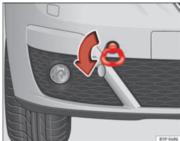
Abb. 207 Frontpartie rechts: Einschrauben der vorderen Abschleppöse
