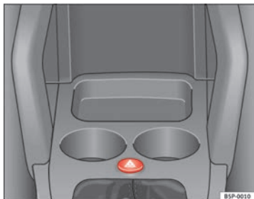
Abb. 77 In der Instrumententafel: Schalter für Warnblinkanlage
