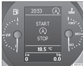
Abb. 142 Anzeige am Display des Kombiinstrumentes während des Start-Stopp-Betriebs
