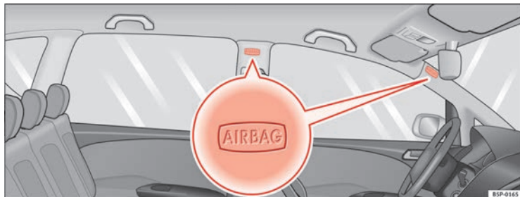
Abb. 24 Einbauort der Kopfairbags auf der linken Fahrzeugseite
