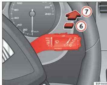
Abb. 89 Scheibenwischer- und Scheibenwaschhebel: Heckscheibenwischer
