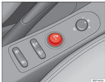
Abb. 118 Der Zigarettenanzünder befindet sich in der Steckdose der vorderen Mittelkonsole
