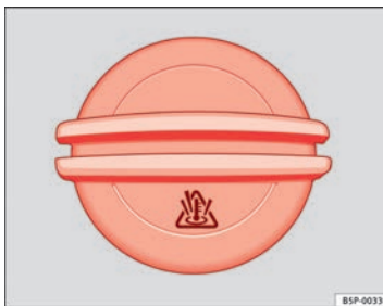
Abb. 169 Im Motorraum: Deckel des Kühlmittel- Ausgleichsbehälters
