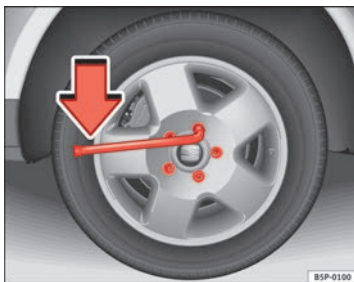
Abb. 179 Radwechsel: Radschrauben lockern
