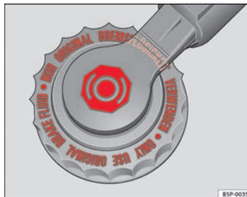
Abb. 174 Im Motorraum: Abdeckung des Bremsflüssigkeitsbehälters
