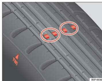
Abb. 175 Prinzipdarstellung Reifenprofil: Verschleißanzeiger
