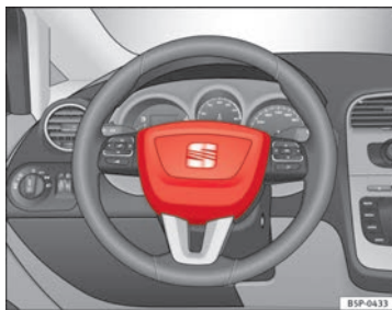
Abb. 18 Einbautort Fahrerairbag: im Lenkrad
