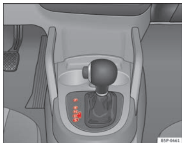
Abb. 145 Mittelkonsole: Wählhebel des Automatikgetriebes / Direktschaltgetriebes DSG
