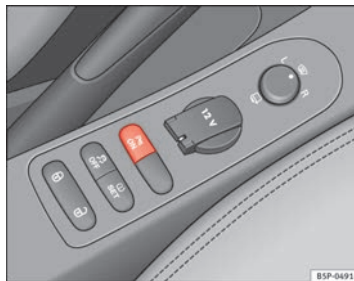
Abb. 152 Mittelkonsole: Schalter für Einparkhilfe
