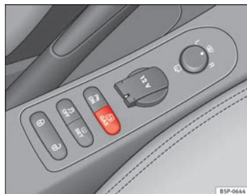
Abb. 140 Mittelkonsole: Kontrollschalter für Autogasanlage.
