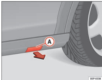
Abb. 182 Kunststoff-Trittleiste mit Deckel zur Aufnahme des Wagenhebers
