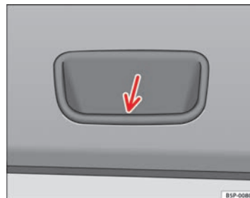
Abb. 67 Ausschnitt aus Innenverkleidung der Heckklappe: Griffmulde zum Zuziehen
