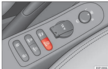
Abb. 121 Mittelkonsole: Kontrollschalter für Autogasanlage.
