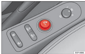
Abb. 110 Der Zigarettenanzünder befindet sich in der Steckdose der vorderen Mittelkonsole.
