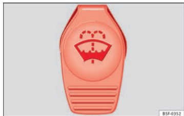
Abb. 162 Im Motorraum: Deckel des Scheibenwaschwasserbehälters
