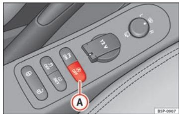
Abb. 137 Ansicht des Tasters für den Start-Stopp-Betrieb
