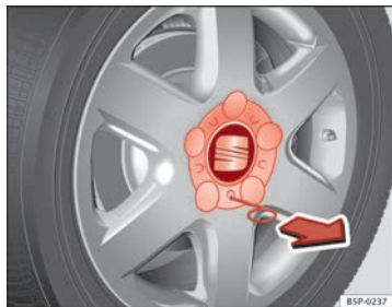
Abb. 171 Radwechsel: Radzierkappe abziehen.
