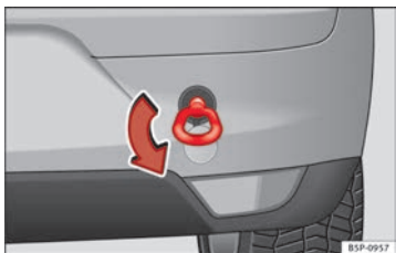
Abb. 211 Einschrauben der Abschleppöse hinten.
