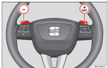
Abb. 144 Lenkrad mit Wippen für Automatikgetriebe.
