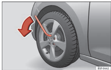
Abb. 173 Radwechsel: Radschrauben lockern
