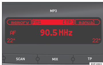
Abb. 130 Display des Radios mit Informationen der Climatronic
