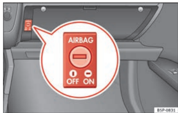
Abb. 22 Im Handschuhfach: Schlüsselschalter zum Ein- und Abschalten des Beifahrer-Airbags
