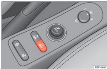
Abb. 48 Mittelkonsole: Taste für die Reifenkontrollanzeige
