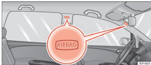
Abb. 26 Lage der Kopfairbags auf der linken Fahrerseite.
