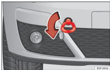
Abb. 210 Frontpartie rechts: Einschrauben der vorderen Abschleppöse.
