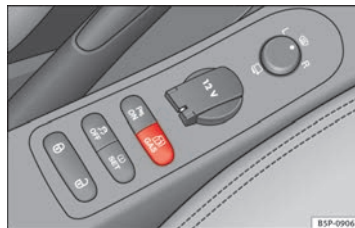
Abb. 136 Mittelkonsole: Kontrollschalter für Autogasanlage.
