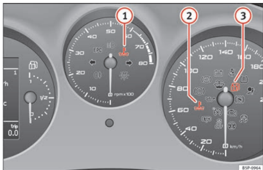
Abb. 47 Kombiinstrument mit Warn- und Kontrollleuchten bei Fahrzeugen mit Autogasanlage.
