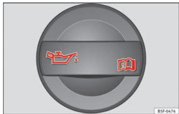
Abb. 160 Deckel der Motoröl-Einfüllöffnung im Motorraum
