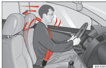
Abb. 10 Richtig angegurte Fahrer werden bei einem plötzlichen Bremsmanöver nicht nach vorne geschleudert.
