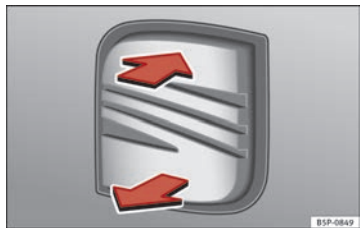
Abb. 62 Heckklappe: Öffnen von außen
