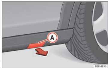
Abb. 176 Kunststoff-Trittleiste mit Deckel zur Aufnahme des Wagenhebers.
