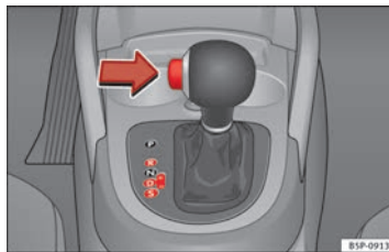
Abb. 142 Mittelkonsole: Wählhebel des Automatikgetriebes
