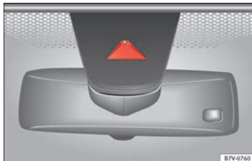
Abb. 149 An der Frontscheibe: Kamerassichtfenster des Spurhalteassistenten.
