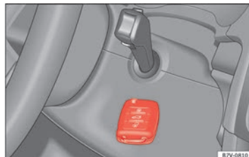
Abb. 127 Notstart bei Fahrzeugen mit KESSY.
