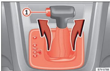
Abb. 203 Abdeckung der Schaltkulisserichtung abbauen.
