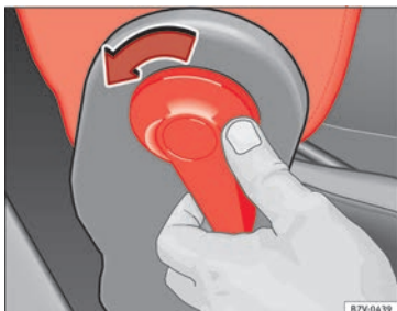
Abb. 85 Klappbare Beifahrersitzlehne entriegeln.
