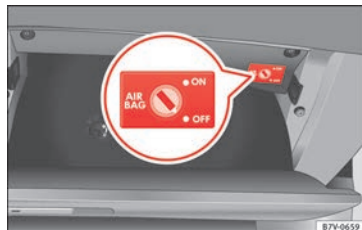
Abb. 22 Im Handschuhfach, auf der Beifahrerseite: Schlüsselschalter zum Ab- und Einschalten des Beifahrer-Frontairbags.
