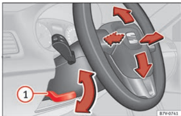
Abb. 3 Lenkradposition mechanisch einstellen.
