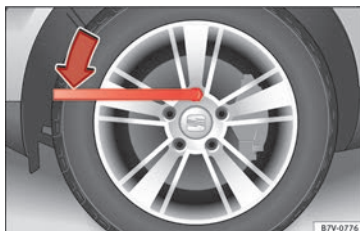
Abb. 185 Radwechsel: Radschrauben lockern.
