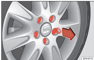
Abb. 184 Abdeckkappen von den Radschrauben abziehen.
