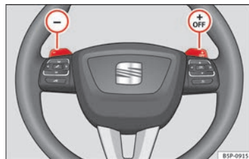
Abb. 132 Lenkrad mit zwei Schaltwippen für die Tiptronic.
