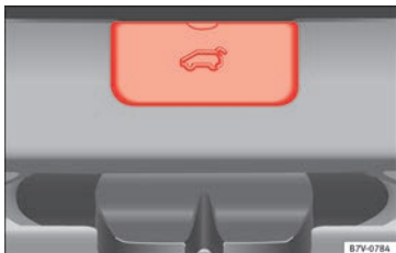
Abb. 199 Vom Gepäckraum aus: Demontage der Abdeckung der Heckklappe.
