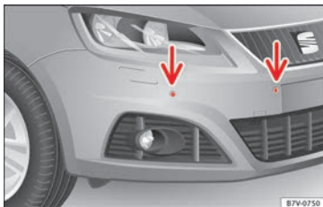
Abb. 138 Sensoren der Parkdistanzkontrolle vorn im Stoßfänger.
