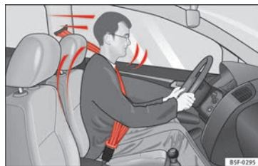
Abb. 6 Angegurteter Fahrer, der bei einem plötzlichen Bremsmanöver vom richtig angelegten Sicherheitsgurt aufgefangen wird.
