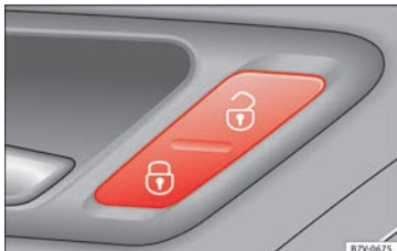
Abb. 45 An der Fahrertür: Zentralverriegelungstaster.
