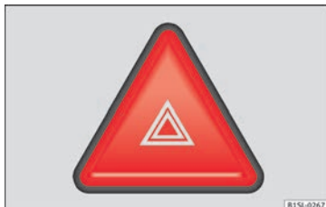
Abb. 179 Ausschnitt von der Instrumententafel: Schalter für die Warnblinkanlage
