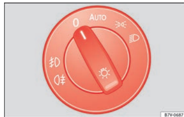
Abb. 60 Neben dem Lenkrad: Darstellung einiger Varianten des Lichtschalters.
