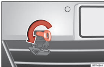
Abb. 194 Im Stoßfänger vorn rechts: Abschleppöse einschrauben.
