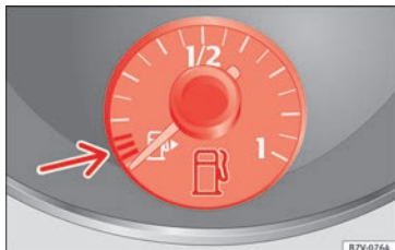
Abb. 158 Im Kombiinstrument: Kraftstoffvorratsanzeige für Benzin und Diesel.
