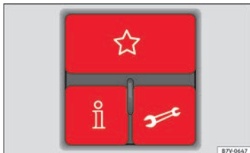
Abb. 38 Drei-Tasten-Modul im Himmel: Bedienelemente des Telefonsteuerungssystems.
