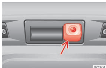
Abb. 143 In der Heckklappe: Einbauort der Kamera des Rückfahrassistenten.
