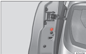
Abb. 197 In der Stirnseite der Beifahrertür: Notverriegelung, durch eine Gummidichtung abgedeckt.
