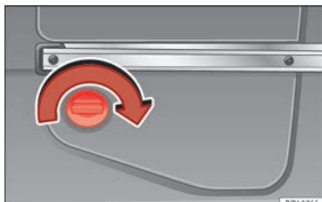
Abb. 160 Hinten links im Gepäckraum: AdBlue-Tank, hinter einer Abdeckung.
