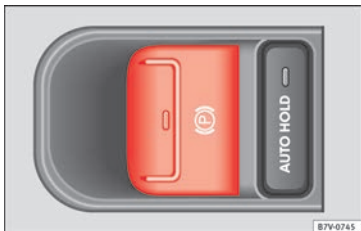
Abb. 128 Detail der Mittelkonsole: Schalter für elektronische Parkbremse.
