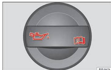
Abb. 166 Im Motorraum: Deckel der Motoröleinfüllöffnung.
