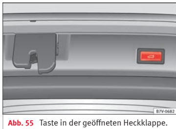
Abb. 55 Taste in der geöffneten Heckklappe.
