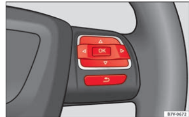
Abb. 37 Multifunktionslenkrad: Tasten zum Bedienen der Menüs im Kombiinstrument.
