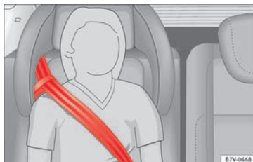
Abb. 31 Integrierter Kindersitz: Gurtbandverlauf mit Gurtführungsschleufe.
