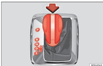
Abb. 130 Wählhebel des automatischen Getriebes mit Sperrtaste (Pfeil).
