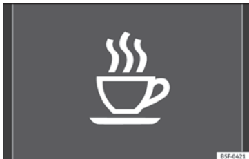
Abb. 151 Im Display des Kombiinstrumentes: Symbol für Müdigkeitserkennung.
