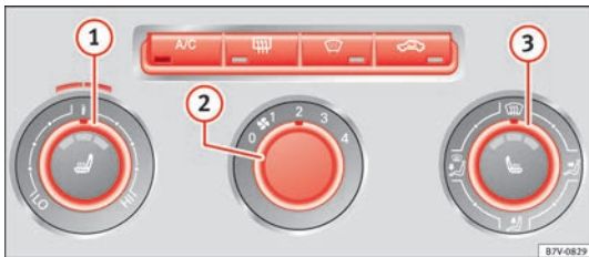
Abb. 120 Ansicht der Mittelkonsole: Bedienelemente der manuellen, elektrischen Klimaanlage
