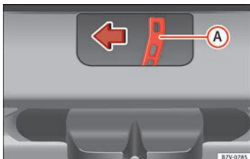
Abb. 200 Vom Gepäckraum aus: Heckklappe notentriegeln.
