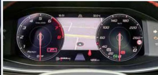
Das digitale Kombiinstrument lässt sich in der Darstellung vielfach anpassen. Im Bild: animierte Rundinstrumente mit Karte
