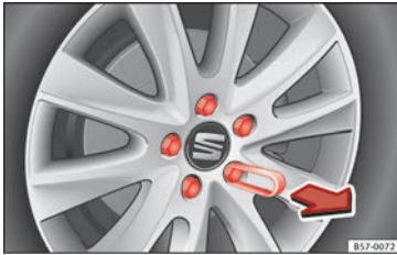
Abb. 79 Rad: Radschrauben mit Deckel.
