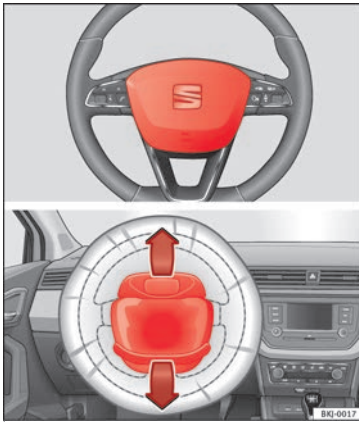
Abb. 20 Einbauort Fahrerairbag: im Lenkrad.
