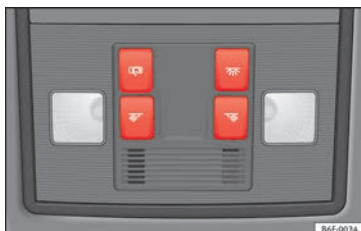
Abb. 40 Ausschnitt aus Dachhimmel: Innenbeleuchtung vorn.
