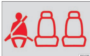
Abb. 96 Kombi-Instrument: Anzeige, dass der Platz hinten rechts besetzt und der entsprechende Sicherheitsgurt angelegt ist.
