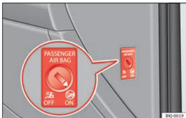
Abb. 102 Schlüsselschalter zum Ein- und Abschalten des Beifahrerairbags.
