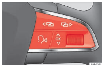
Abb. 45 Rechte Seite Multifunktions-Lenkrad: Steuertasten.
