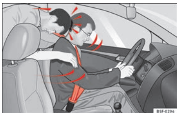
Abb. 99 Der nicht angesicherte Mitfahrer auf dem Rücksitz schleudert nach vorn auf den angesicherten Fahrer.
