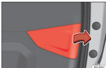
Abb. 117 Gepäckraumklappe geöffnet: Abdeckung abziehen.
