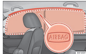
Abb. 25 Einbauort und Entfaltungsbereich des Kopfairbags.
