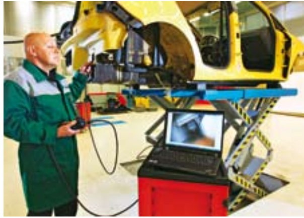
Heißwaxsspuren: Der DEKRA-Sachverständige Günther Schiele begutachtet per Endoskop die Hohlraumkonservierung des ausgeräumten Ibiza. Schwachstellen entdeckt er dabei nicht
